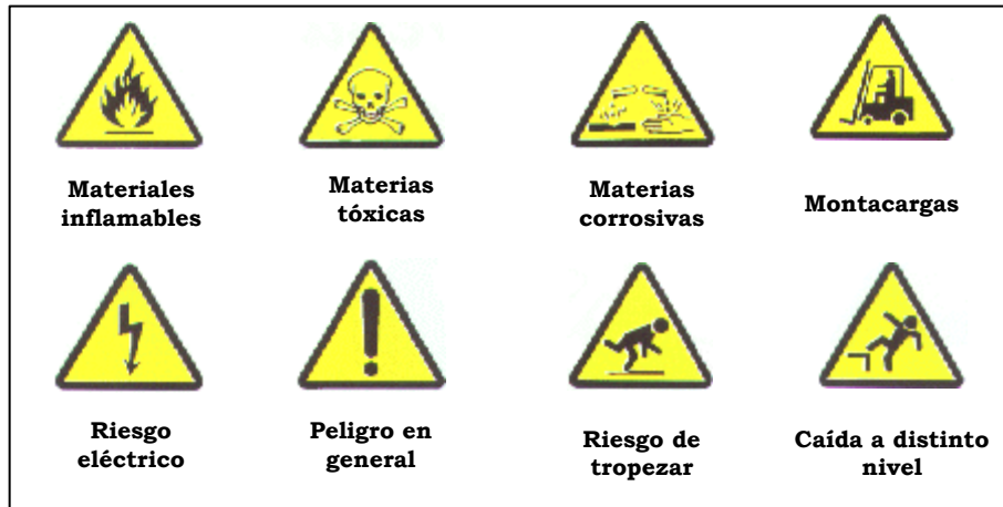
Figura 39 Señales de Advertencia.
