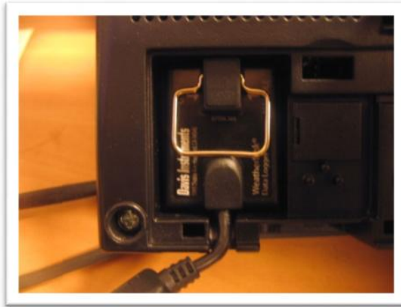
Figura 42. Instalación del Datalogger
