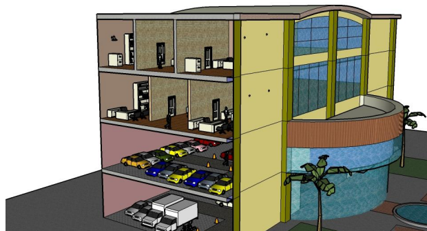
Fig. 2.54. En el primero y segundo nivel del edificio de la figura se observa que se ha utilizado como parqueo y en el tercero y cuarto nivel como oficinas, esto produce diferencia de peso en los niveles de la estructura.
