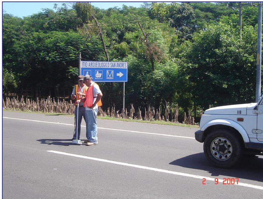
Fig. 3.106 Toma de datos con Perfilómetro ROMDAS Z-250
