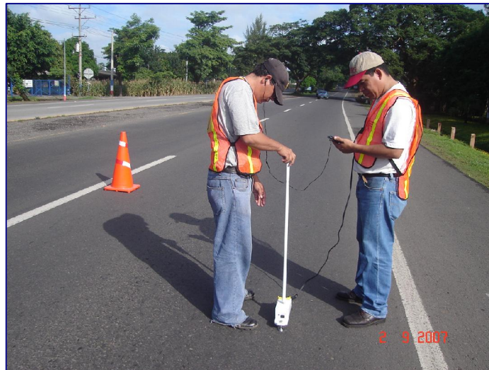
Fig. 3.108 Operación del Perfilómetro ROMDAS Z-250
