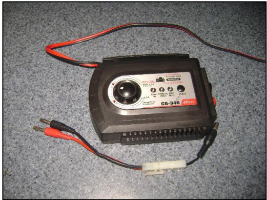
Fig. 3.11 Cargador de Batería 12 Voltios (Con adaptador para cargar en un vehículo)
