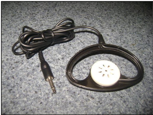
Fig. 3.16 Audífonos para escuchar las señales emitidas por el Z-250 en el campo.
