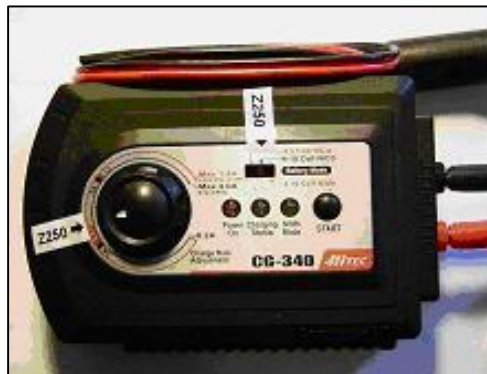
FIG. 3.22 Cargador hitec cg-340 del Perfilómetro Z-250.
