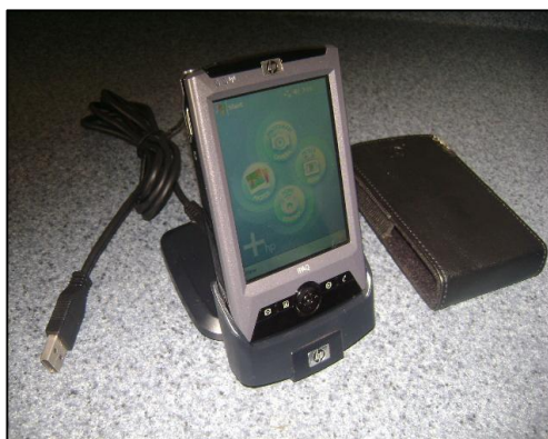
Fig. 3.19 Base con conexión RS-232 y USB
