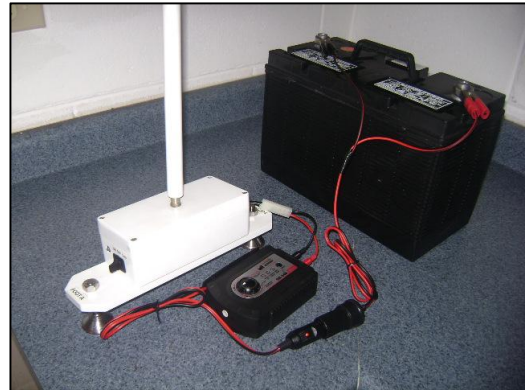
Fig. 3.11 Cargador de Batería 12 Voltios (Con adaptador para cargar en un vehículo)
