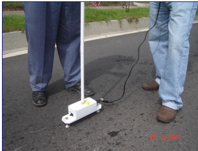
Fig. 3.121 Toma de datos con Perfilómetro ROMDAS Z-250
