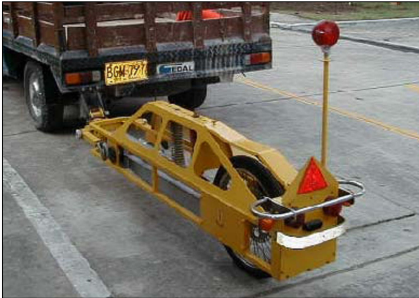
Figura 2.4 El Analizador de Perfiles Longitudinales (APL)
