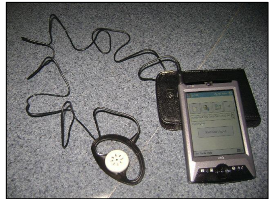
Fig. 3.16 Audífonos para escuchar las señales emitidas por el Z-250 en el campo.
