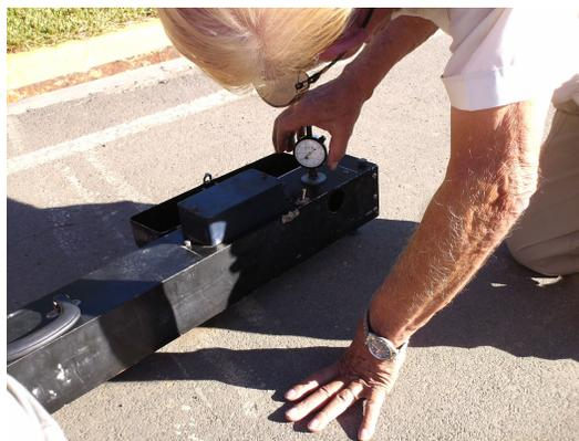
**Fig. 3.14 Colocación del limbo comparador hasta que la aguja marque cero**
