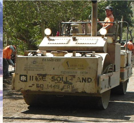
**Fig. 2.5 Rodillo vibratorio ruedas metálicas**
