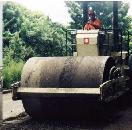
**Fig. 2.6 Rodillo vibratorio pata de cabra y rodillo vibratorio liso.**
