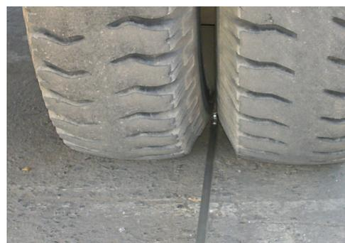
**Fig. 3.12 Colocación del extremo de medida entre las ruedas gemelas del camión.**
