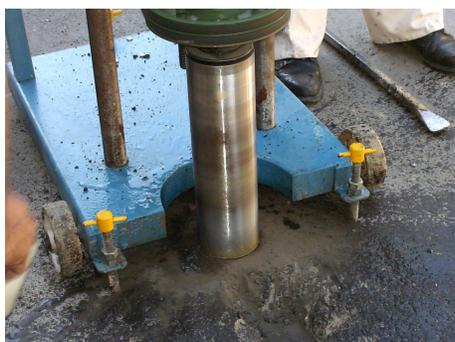
**Fig. 3.55 Extracción de núcleos**
