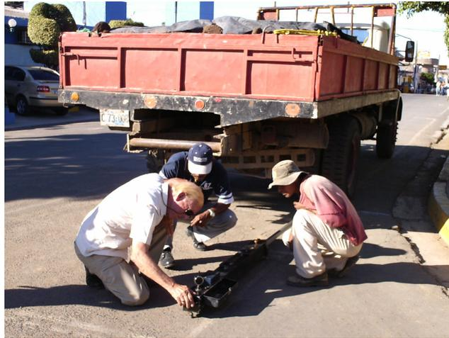
**Fig. 3.13 Ajuste de la parte trasera de la viga para lograr el apoyo del extremo en el vástago móvil**
