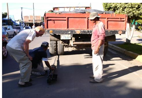
**Fig. 3.11 Colocación de la viga Benkelman**
