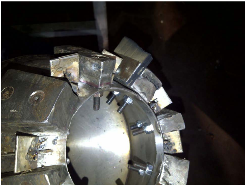
Figura 3-29 correcciones en la cámara de despulpado.
