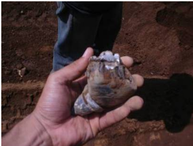
Fotografía 11: Se observa un diente perteneciente a un disco de corte de una máquina mezcladora, que fue desprendido de la misma durante la operación de mezclado de materiales, al encontrarse con roca en el lugar.
