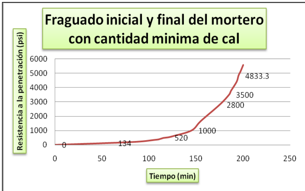
Figura 4.16 Tiempos de fraguado del mortero con contenido mínimo de cal
