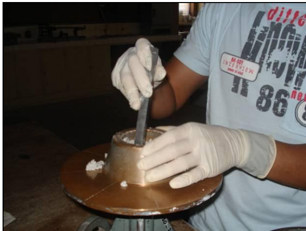
Figura 3.6 Apisonado Del Mortero En El Molde De Fluidez.
