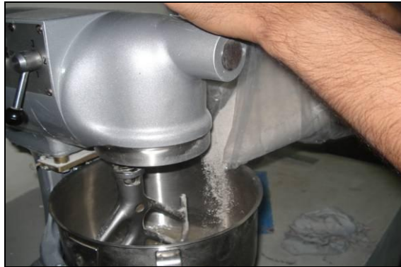
Figura 3.24 Mezclado del cementante predosificado con el agua.
