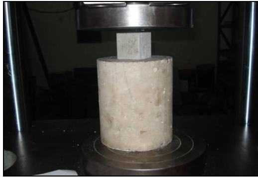
Figura 3.14 Ensayo A Compresión De Especimen En Maquina Universal.
