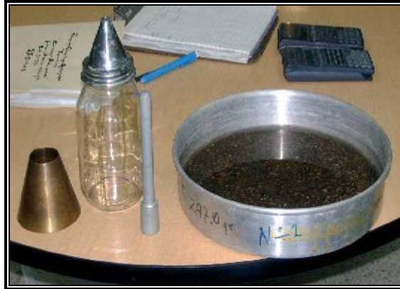
Figura 4.10 Equipo para realización de ensayo de gravedad específica y absorción.
