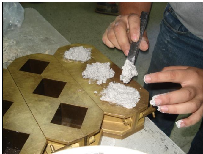
Figura 4.12 Llenado de cubos con mortero.
