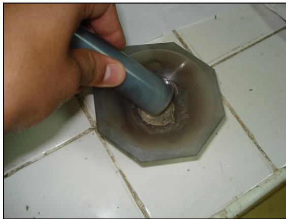
Figura 3.41 Pulverización de la muestra con mortero de Ágata.
