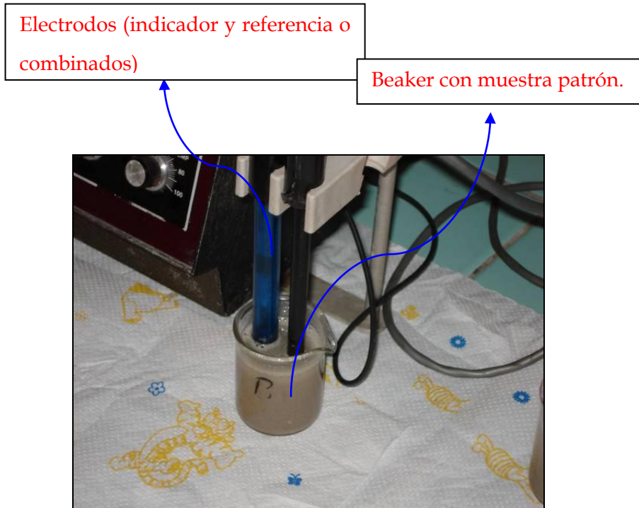
Figura 3.34 Introducción de los electrodos en la muestra.
