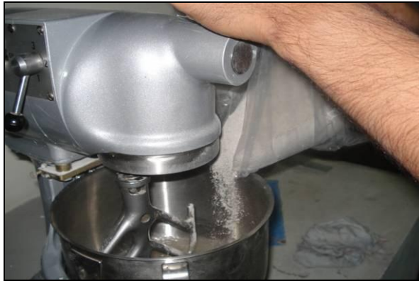
Figura 3.4 Colocación Del Agua y El Cemento En El Tazón De Mezclado.
