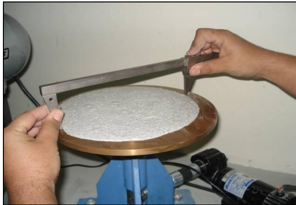
Figura 3.7 Medición de la fluidez.
