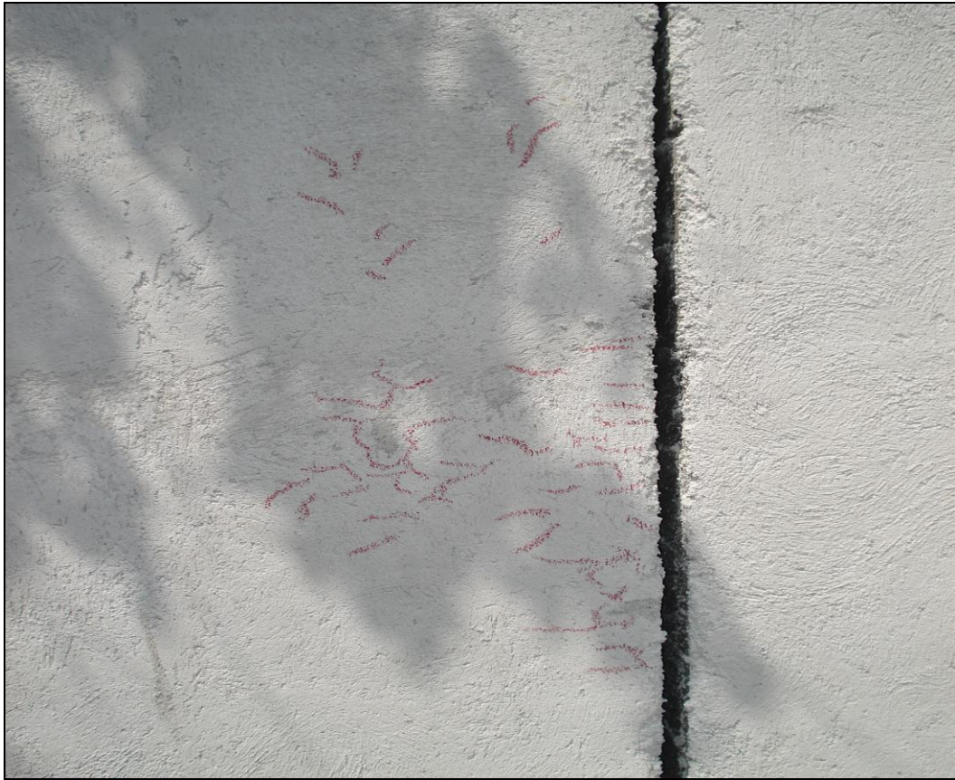
Figura 5.5 Repello con mortero elaborado con cemento Pórtland mezclado con el contenido mínimo de cal a los 7 días de haber sido colocado.
