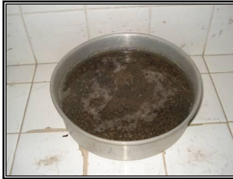
Figura 4.9 Muestra sumergida por 24 horas.
