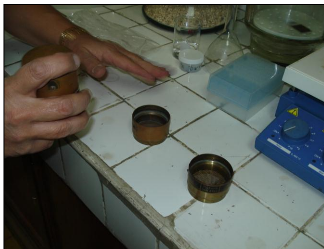
Figura 3.49 Separación del material grueso del fino por medio de malla N° 200.
