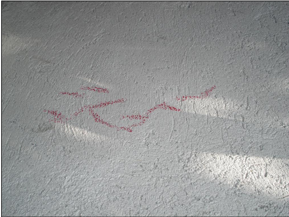
Figura 5.6 Repello con mortero elaborado con cemento Pórtland mezclado con el contenido mínimo de cal a los 14 días de haber sido colocado.
