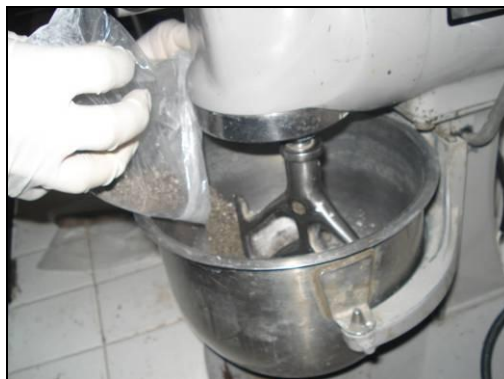
Figura 3.5 Adición De Arena A La Pasta De Cemento.
