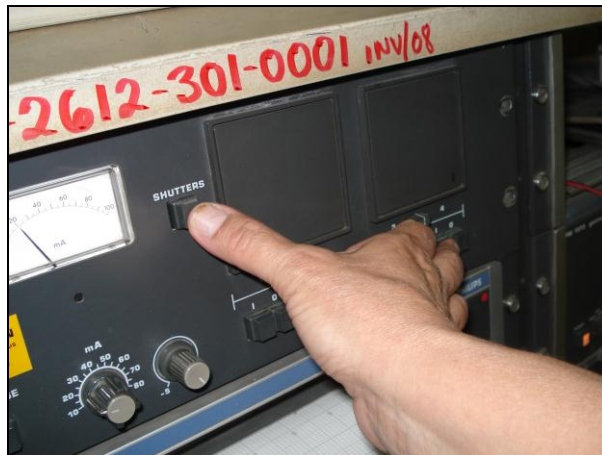
Figura 3.48 Apertura del tubo de rayos X.
