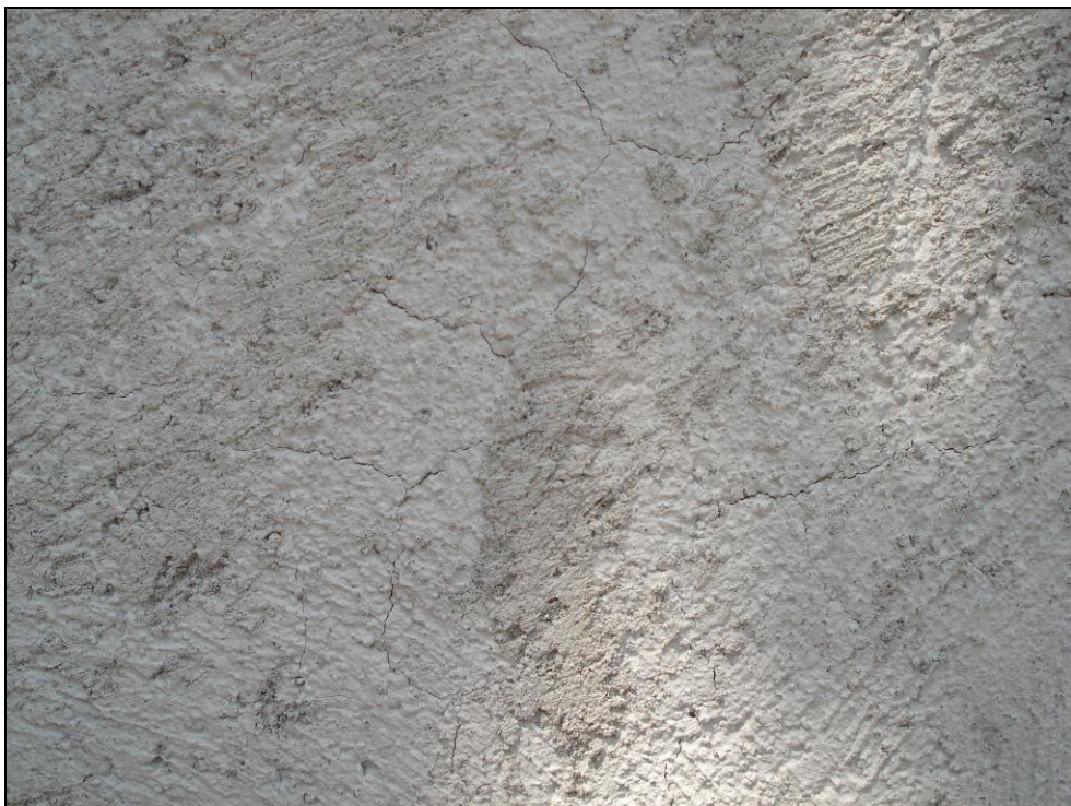
Figura 5.4 Repello con mortero elaborado con cemento Pórtland mezclado con el contenido mínimo de cal a los 3 días de haber sido colocado.
