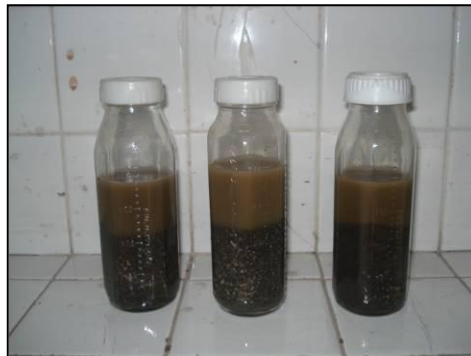
Figura 4.4 Mezcla de hidróxido de sodio con arena.
