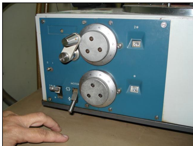
Figura 3.47 Fijación del ángulo de inicio del goniómetro.
