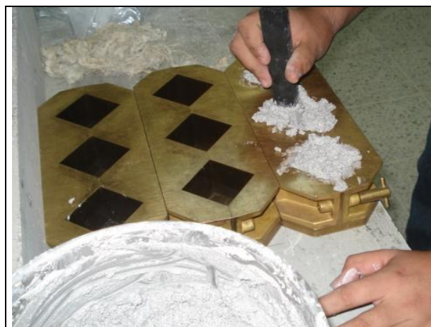
Figura 3.13 Apisonado Del Mortero En Los Moldes.
