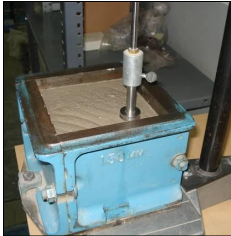
Figura 3.19 Introducción de la aguja de 1 pul en el mortero.
