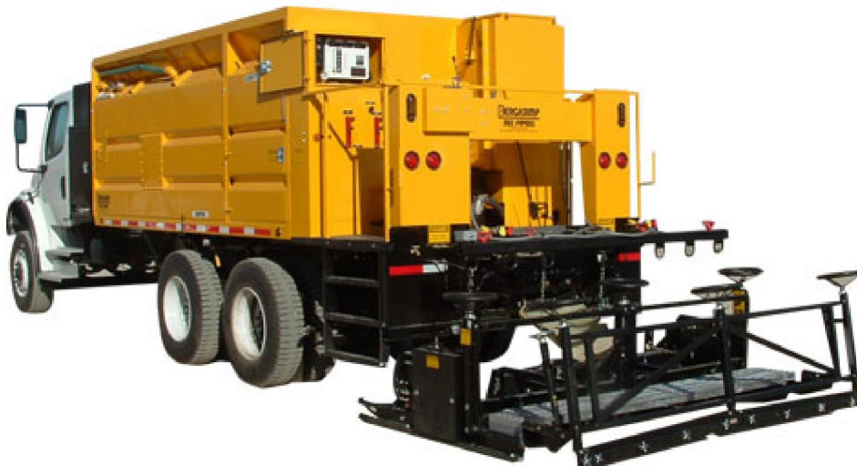
Fotografía 8.6 Maquina Bergkamp, Camión de fabricación de Microsurfacing
