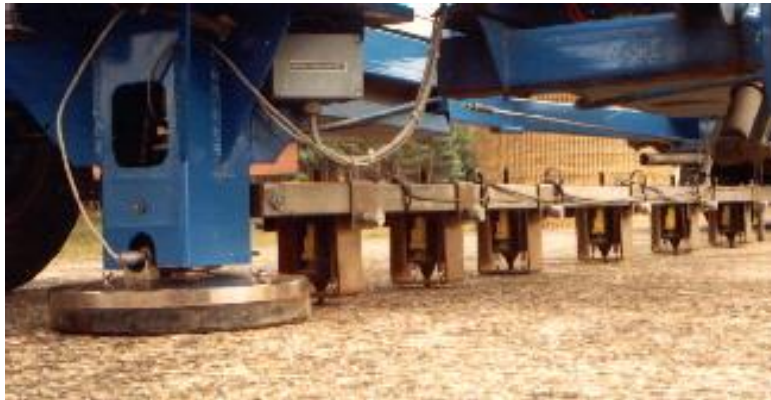
Fig. 2.17. Vista inferior del plato de carga y geófonos (FWD 8000)
