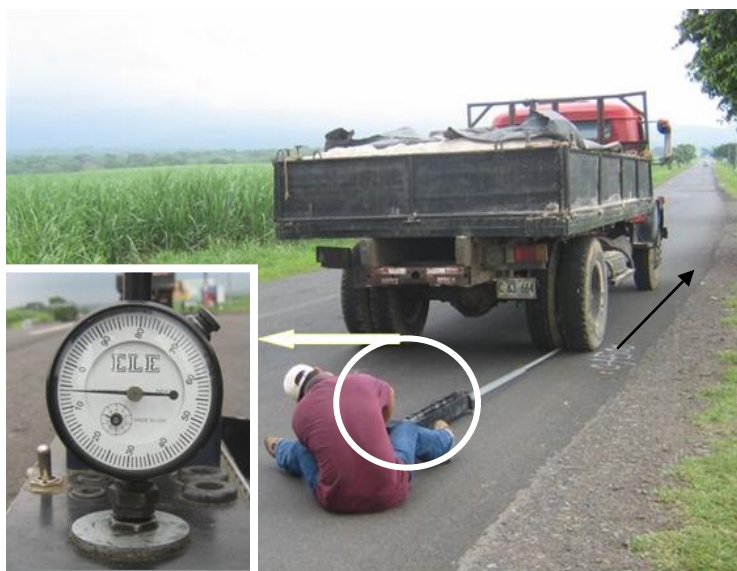
Fig. 4.2 Colocación típica de la Viga Benkelman
