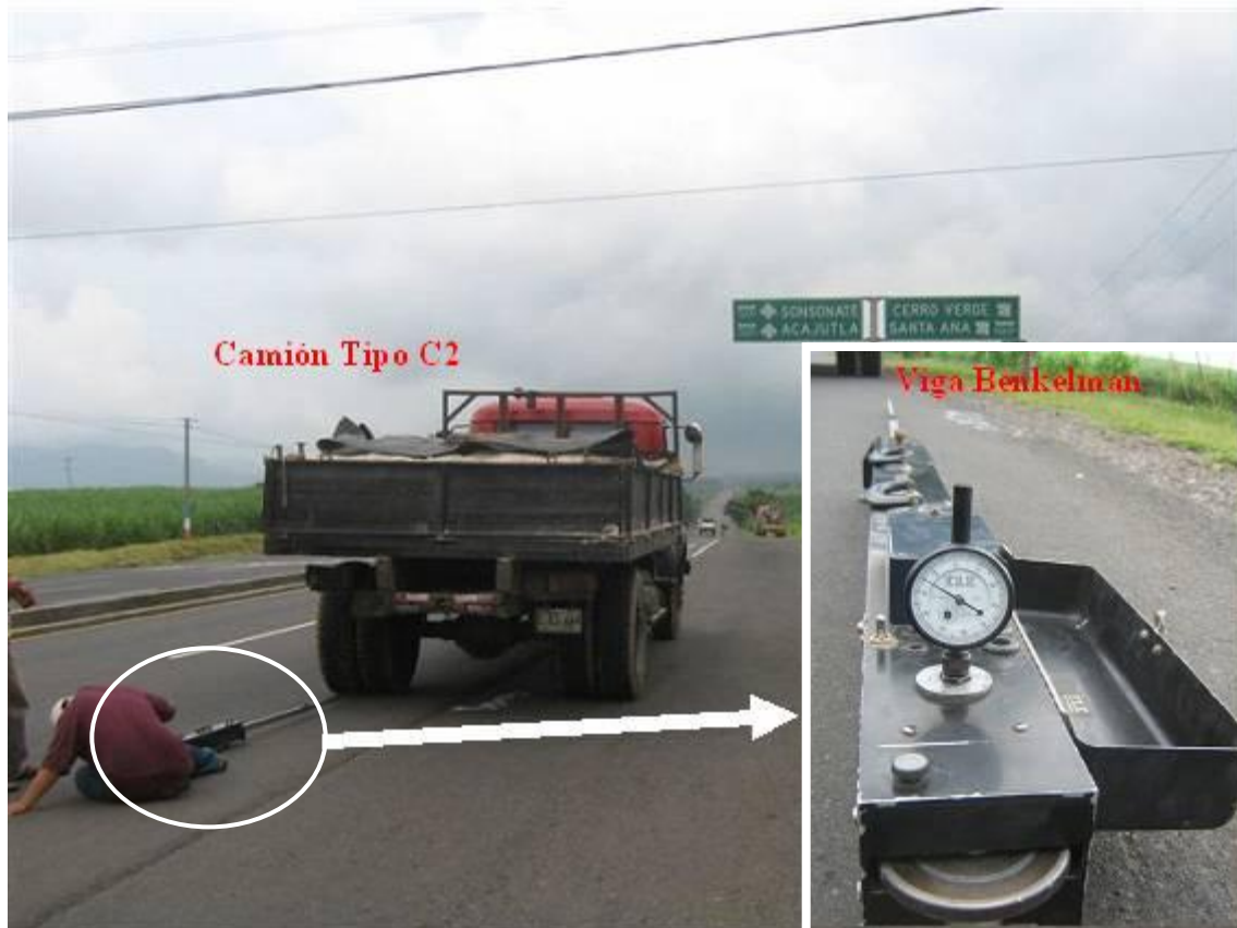
Fig. 3.3 Colocación de la Viga Benkelman, Posición inicial y final.
