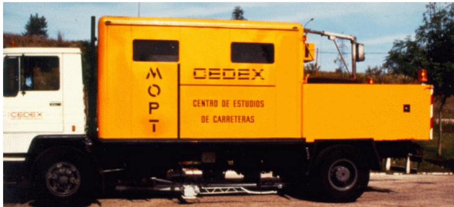
Fig. 2.12. Deflectógrafo tipo Lacroix, Equipo semicontinuo
