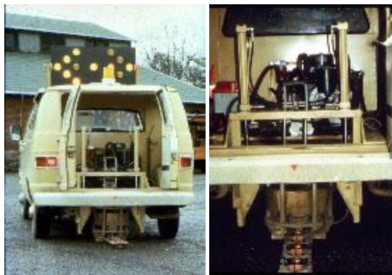
Fig. 2.15. Equipo Road Rater (Electro – hidráulico)
