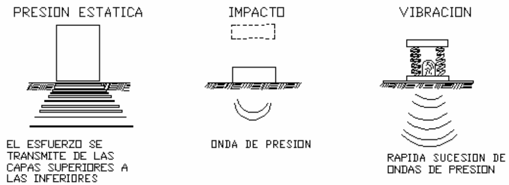
Figura 1.18 Diferentes formas de transmisión de esfuerzos al suelo.
