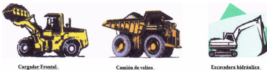
Figura 7.6 Representación esquemática de un cargador frontal, un camión de volteo y una excavadora hidráulica
