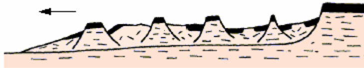
Figura 2.7. Fluencia y extrusión del material por licuefacción.
