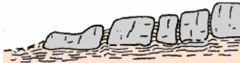
FIGURA 2.8. Fluencia y extrusión del material subyacente.
