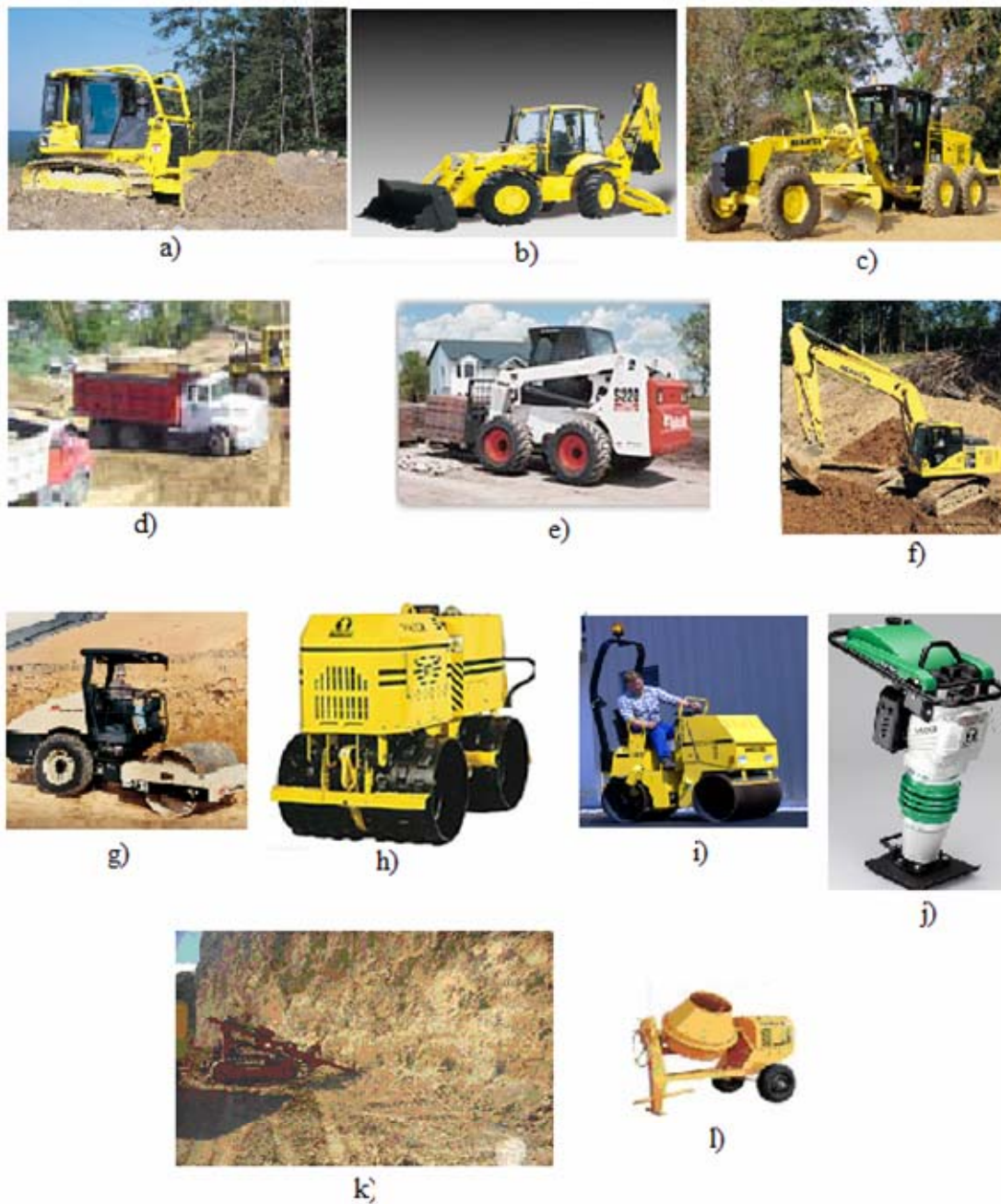
Figura 4.2. Maquinaria comúnmente utilizada en los métodos de reducción de fuerzas actuantes. a) tractor, b) retroexcavadora, c) motoniveladora, d) camiones de volteo, e) mini cargador, f) pala mecánica, g) rodillo liso, h) rodillo pata de cabra, i) rodillo liso liviano, j) compactador manual (bailarina), k) perforadora y l) mezcladora.
