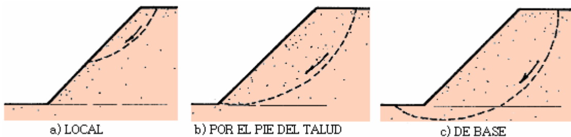
Figura 3.3. Tipos de fallas en deslizamientos rotacionales
