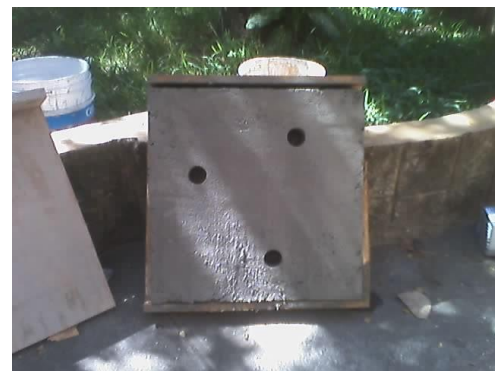
Fotografía 4.20 Muestra de panel donde se extrajeron Núcleos
