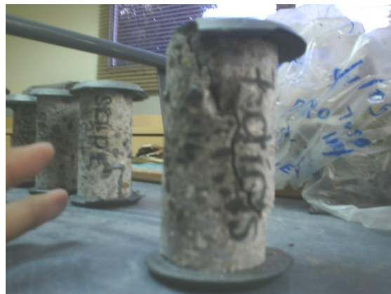
Fotografía 4. 30 Falla de núcleo
