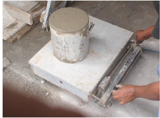
Fotografía 4. 14 Muestra de Peso Volumétrico en la mezcla de concreto para el tipo de Cemento C-1157.
