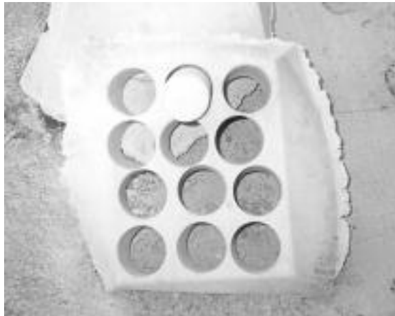
Fotografía 3. 10 Extracción de núcleos
