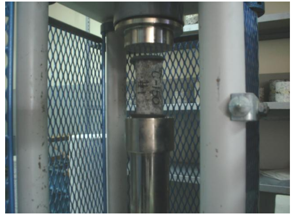
Fotografía 4. 29 Ensayo a la compresión de núcleos
