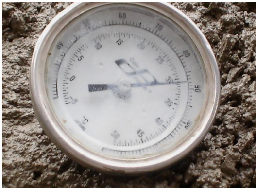
Fotografía 4.5 Medición de Temperatura al concreto usando cemento C-150
