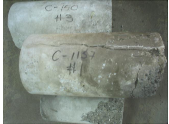
Fotografía 4. 27 Ruptura de cilindros
