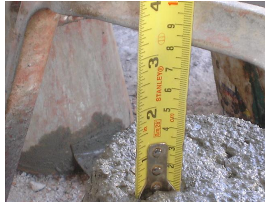
Fotografía 4.10 Resultado de revenimiento para el concreto con cemento C - 150, realizado en campo.
