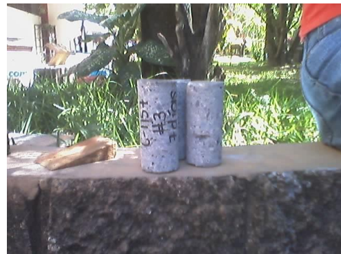
Fotografía 4.18 Muestras de Núcleos extraídos de un panel de Concreto Lanzado
