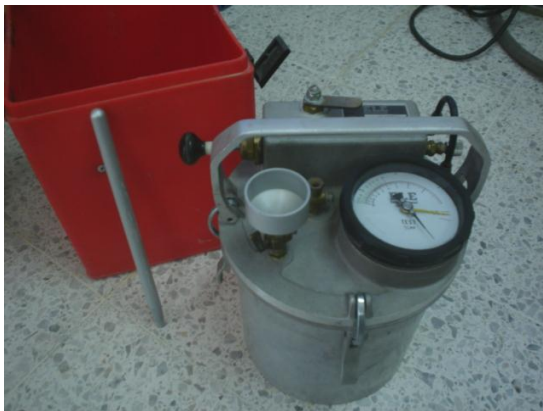
Fotografía 4.7 Equipo de medición para el contenido de aire del concreto
