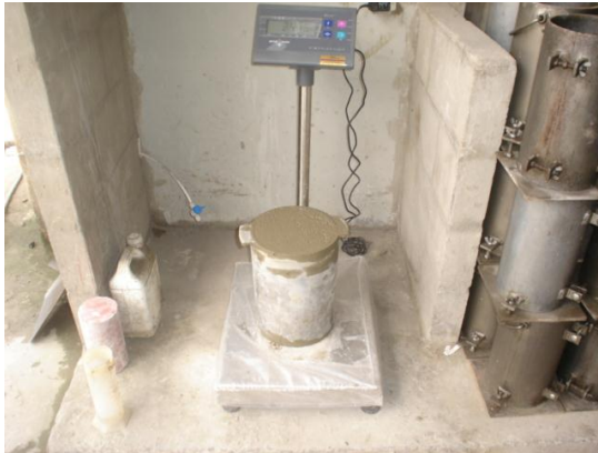
Fotografía 4. 13 Muestra de Peso Volumétrico en la mezcla de concreto para el tipo de Cemento C-150.
