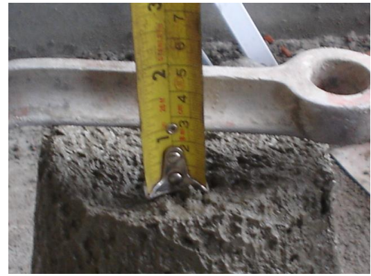
Fotografía 4.12 Resultado de revenimiento para el concreto con cemento C - 1157, realizada en campo.
