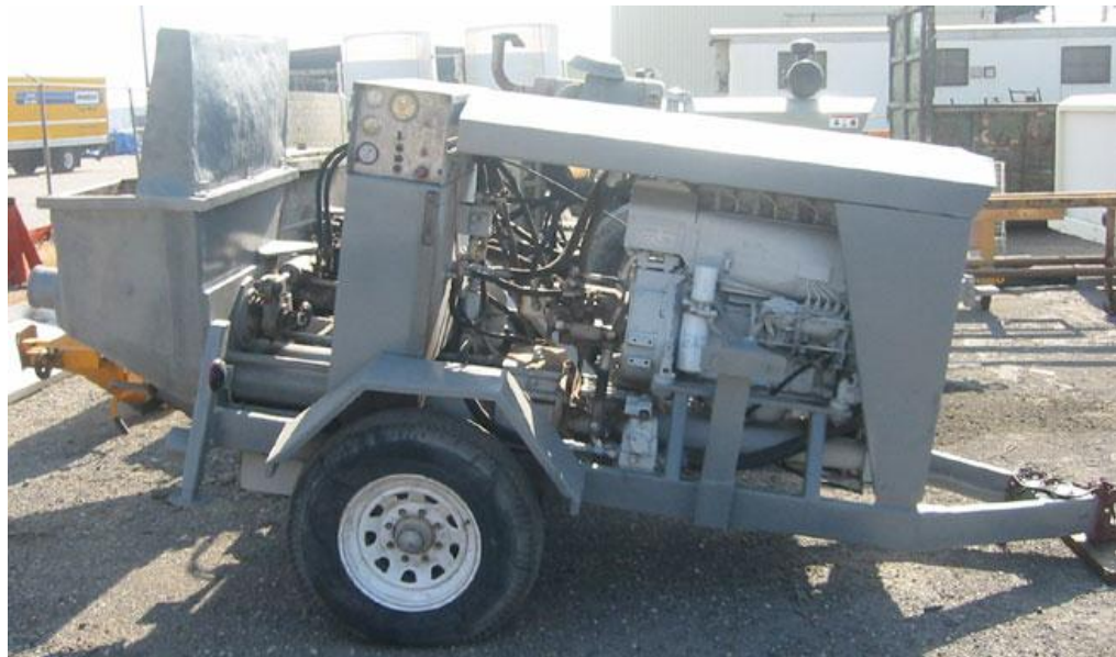
Fotografía 2. 21 Equipo de Lanzadora de mezcla húmeda
