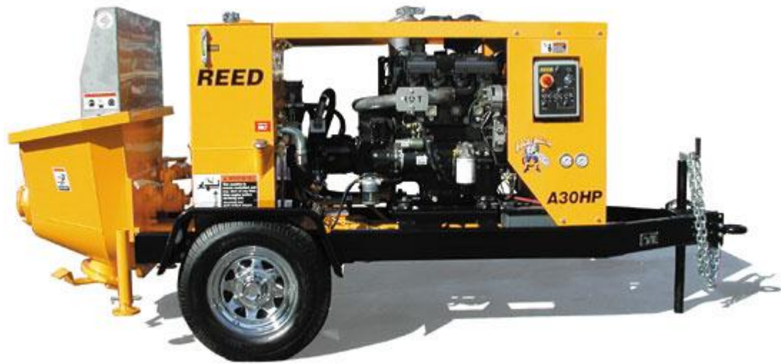
Fotografía 2. 20 Equipo de Lanzadora de mezcla húmeda
