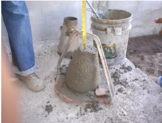
Fotografía 4.9 Prueba de revenimiento realizada en el de concreto con cemento C - 150
