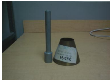
Fotografía 4. 3 Molde de Cono y Pisón para encontrar el estado de saturada superficialmente seca de la arena
