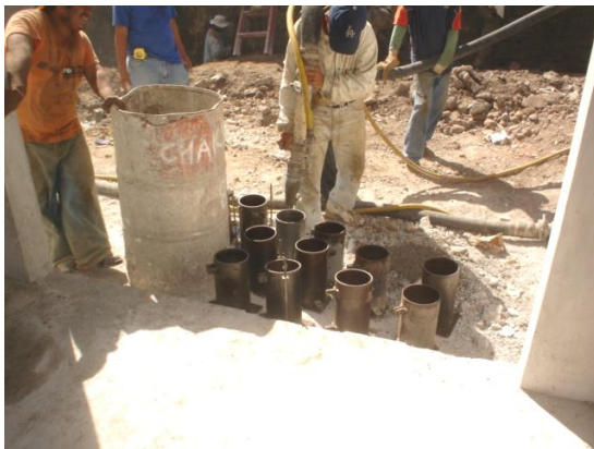
Fotografía 4. 15 Elaboración de cilindros
