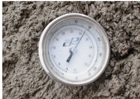
Fotografía 4.6 Medición de Temperatura usando cemento C-1157
