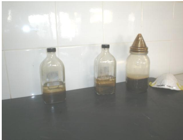
Fotografía 4. 2 Muestra del agregado fino de la prueba de impurezas inorgánicas.
