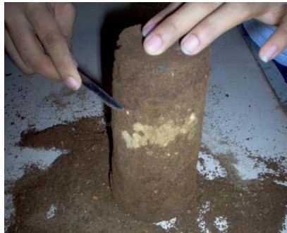
Figura 14.5 Labrado del espécimen para ensayo triaxial.
