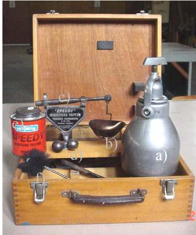
Figura 4.1 Equipo “Speedy”: a) cámara de ensayo con indicador de presión; b) tara; c) balanza; d) bolas de acero; e) reactivo; e) cepillo.
