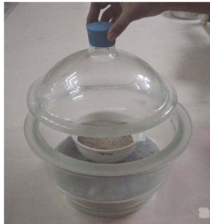
Figura 3.3 Muestra de suelo seco en un recipiente de porcelana colocado dentro de un desecador.
