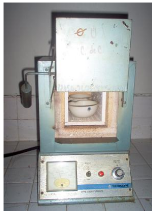
Figura 9.3 Colocación en el horno mufla del recipiente conteniendo la muestra.
