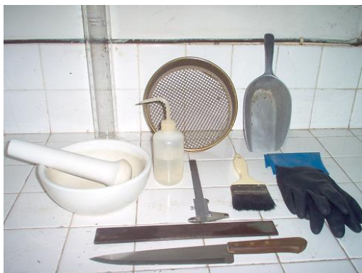
Figura 10.2 Equipo utilizado durante el ensayo de compactación.
