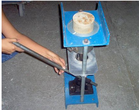
Figura 11.6 Extracción de la muestra utilizando gato hidráulico
