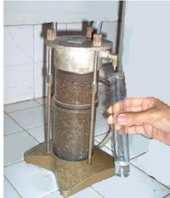
Figura 17.8 Medición del volumen de agua utilizando una probeta graduada en el ensayo de permeabilidad.
