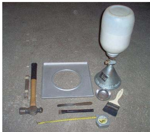
Figura 12.1 Equipo utilizando en la determinación de la densidad in situ.
