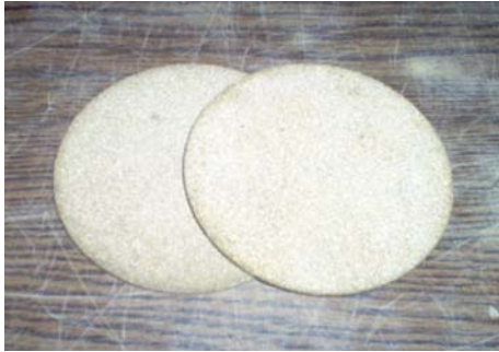
Figura 15.3 Placas porosas para permitir el drenaje del espécimen en el ensayo de corte.
