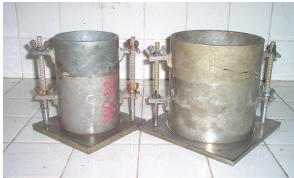
Figura 11.1 Moldes de compactación de 4” y 6” de diámetro.
