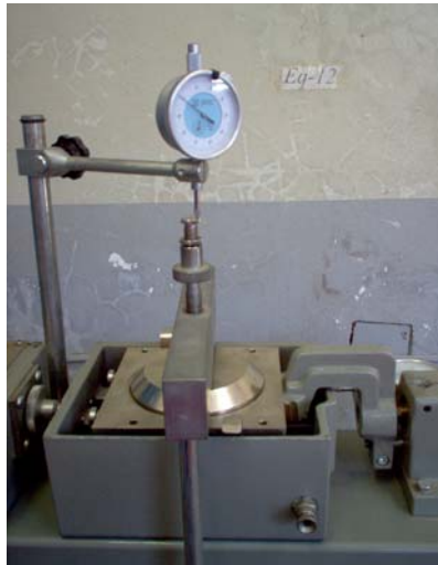
Figura 15.8 Lectura del deformímetro vertical durante la realización del ensayo
