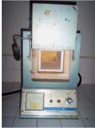
Figura 9.1 Horno mufla utilizado en la determinación del contenido de ceniza.
