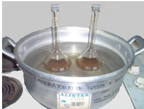
Figura 5.4 Desaireado de la lechada por el método de ebullición.
