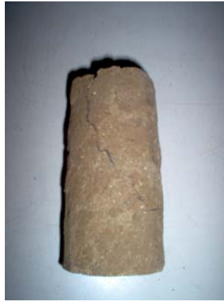
Figura 14.11 Superficie de falla ocurrida en el espécimen durante el proceso de carga en el ensayo triaxial.
