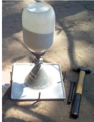
Figura 12.3 Llenado con arena del agujero de ensayo.
