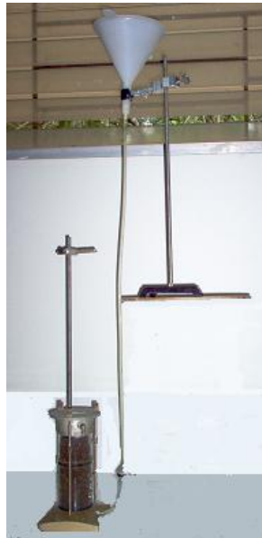
Figura 17.7 Montaje del permeámetro para la realización del ensayo de la permeabilidad.
