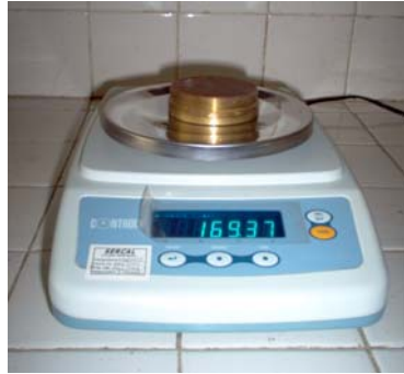
Figura 16.5 Determinación de la masa húmeda del espécimen + anillo de consolidación.
