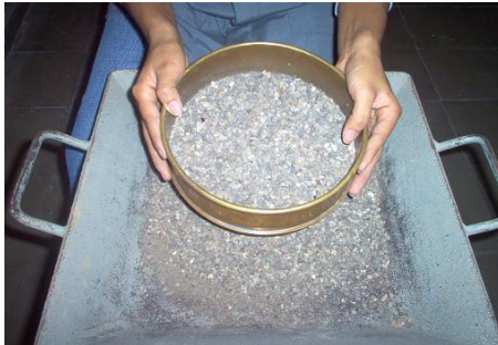
Figura 6.3 Separación de la muestra de suelo por la malla No 10 en el análisis granulométrico.
