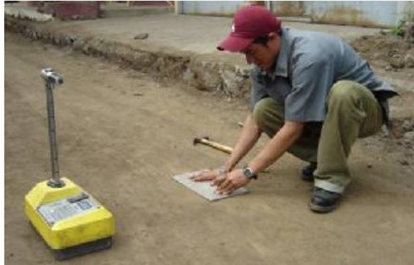
Figura 13.3 Aplanado o raspado de la superficie del suelo a ensayar para la determinación de la densidad del suelo y suelo agregado en el lugar, por métodos nucleares.
