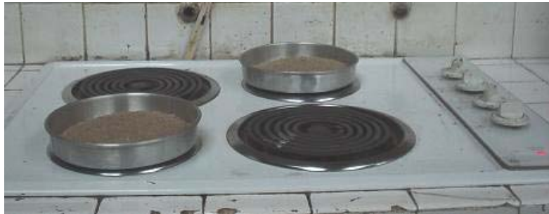
Figura 2.2 Aplicación de calor al recipiente y muestra de suelo húmedo en la cocina eléctrica.
