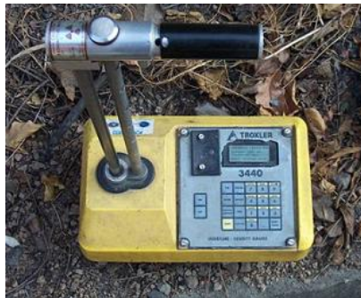
Figura 13.1 Densímetro nuclear, utilizado para la determinación de la densidad del suelo en el lugar.
