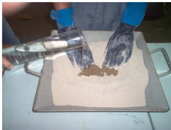
Figura 10.3 Humedecimiento de la muestra para obtener la humedad requerida para el ensayo Proctor.
