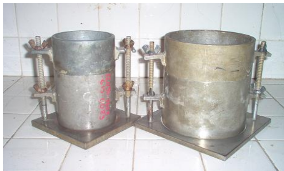
Figura 10.1 Moldes para ensayos de compactación Proctor de 4” y 6” de diámetro
