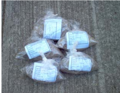
Figura 18.6 Muestras obtenidas del ensayo SPT colocadas en bolsas plásticas con su correspondiente identificación.
