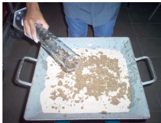
Figura 11.3 Humedecimiento de la muestra para obtener la humedad requerida para el ensayo Proctor.
