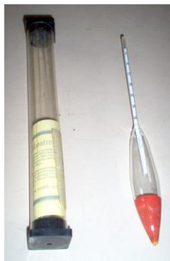
Figura 6.1 Hidrómetro 152 H utilizado en el análisis de las partículas que pasan el tamiz No.10
