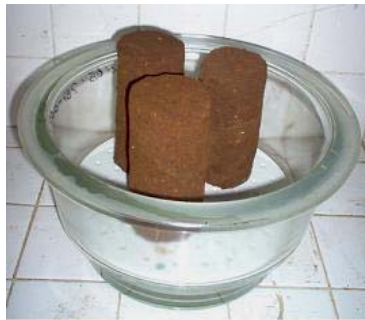
Figura 14.6 Especímenes de ensayo colocados en un desecador.
