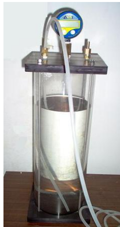
Figura 14.2 Aparato de control de presión para el ensayo triaxial.
