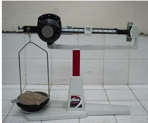
Figura 1.3 Determinación de la masa de la muestra de suelo, con balanza de 0.01 g de precisión.
