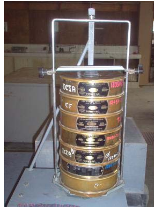
Figura 6.7 Ensamble y tamizado de la muestra utilizando un agitador mecánico.
