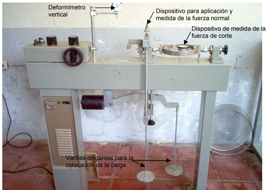
Figura 15.1 Aparato para la realización del ensayo de corte directo.
