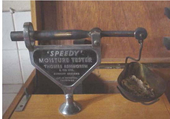
Figura 4.3 Determinación de la masa de la muestra de suelo húmedo (20 g).
