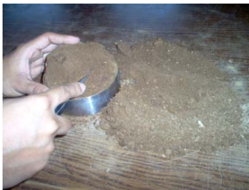
Figura 15.5 Corte del material que rebasa en uno de los extremos del anillo cortante.
