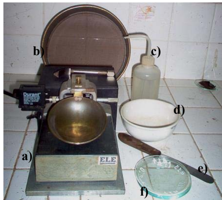
Figura 7.2 Equipo utilizado durante el ensayo del límite líquido; a) Copa de Casagrande; b) tamiz No.40; c) piseta d) recipiente de porcelana; e) espátula; f) recipientes para contenido de humedad (vidrio reloj).
