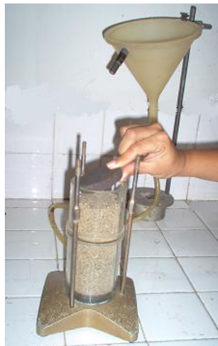
Figura 17.6 Colocación de la placa porosa sobre el suelo compactado en la realización del ensayo de permeabilidad.
