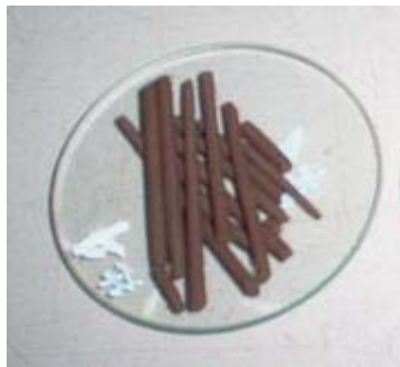
Figura 7.10 Porciones de suelos resquebrajado obtenidas durante el ensayo del límite plástico.
