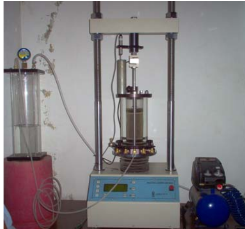
Figura 14.10 Aplicación de la carga axial al espécimen durante el ensayo triaxial
