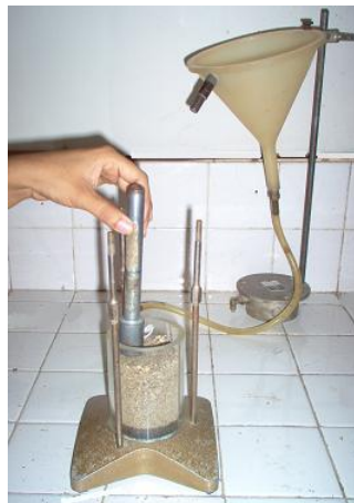
Figura 17.5 Compactación de la capa de suelo colocada en el permeámetro utilizando un apisonador, en el ensayo de permeabilidad.
