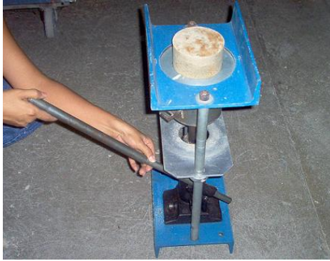
Figura 10.6 Extracción de la muestra utilizando gato hidráulico
