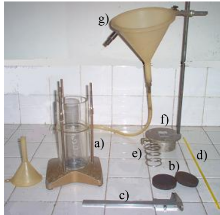
Figura 17.3 Equipo utilizado en el ensayo para la determinación de la permeabilidad: a) cilindro de permeabilidad, b) discos porosos, c) vernier, d) termómetro, e) resorte, f) tapa del cilindro de permeabilidad, g) embudo.
