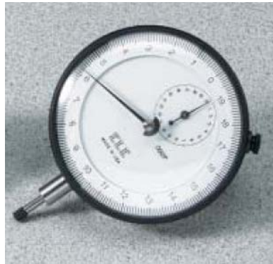
Figura 16.3 Indicador de lecturas de deformación para el ensayo de consolidación.
