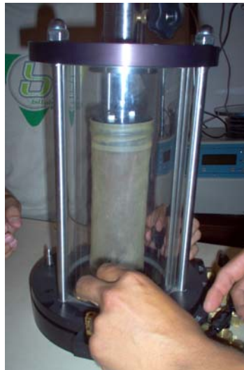
Figura 14.9 Instalación de la cámara triaxial sobre el espécimen.
