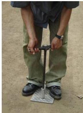
Figura 13.5 Remoción de la varilla de perforación utilizando el extractor.
