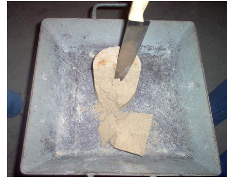
Figura 11.7 Corte de la muestra para obtener la humedad del suelo.
