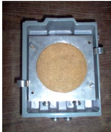
Figura 15.6 Colocación del espécimen a ensayar en la caja de corte.
