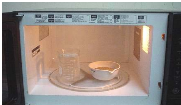
Figura 3.2 Recipiente de porcelana con muestra de suelo húmedo, junto con un Beakers de vidrio lleno con agua, colocados dentro de un horno microonda.
