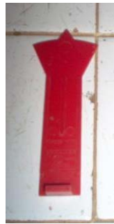
Figura 7.1 Ranurador plástico utilizado para la abertura de la ranura del suelo.
