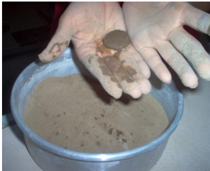
Figura 8.6 Proceso de agitado del suelo en dirección horizontal.
