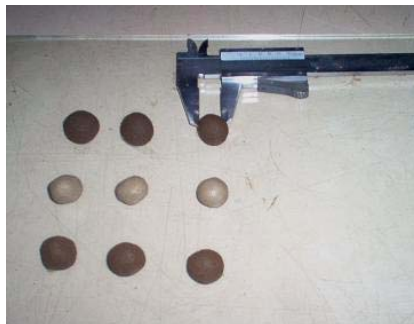
Figura 8.5 Especímenes de ensayo con diámetro aproximado de 12 mm.
