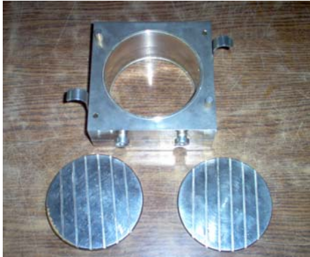
Figura 15.2 Caja de corte de forma circular y placas ranuradas para el ensayo de corte directo.
