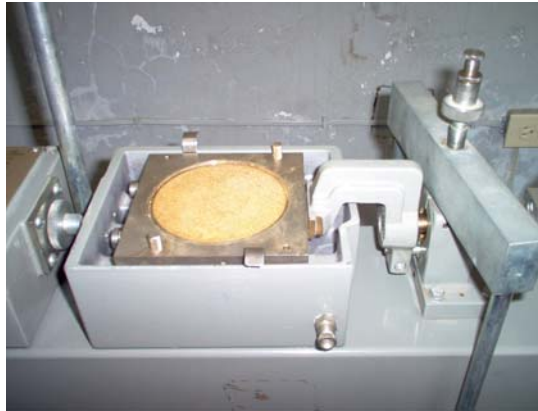
Figura 15.7 Colocación de la caja de corte en el carro deslizable.
