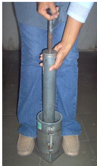
Figura 10.4 Compactación de la primera capa de suelo en un molde Proctor.
