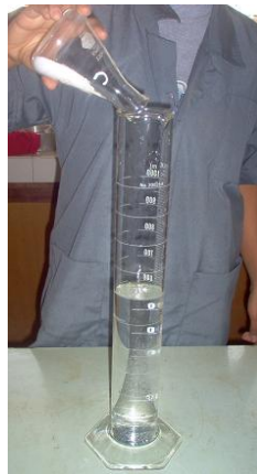
Figura 6.4 Preparación de la solución dispersante para el análisis hidrométrico del suelo.
