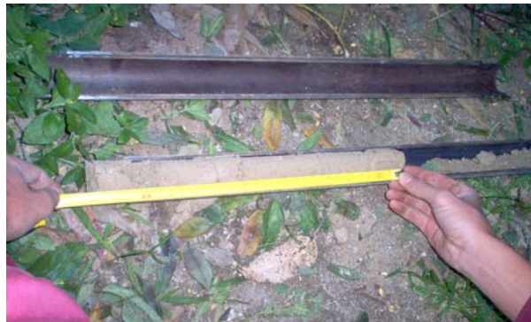
Figura 18.5 Medida de la longitud de recuperación de la muestra de suelo obtenida durante el ensayo de penetración estándar.
