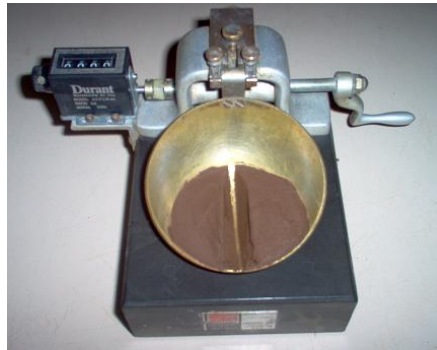
Figura 7.6 Muestra de la ranura del suelo en la copa del aparato para límite líquido.
