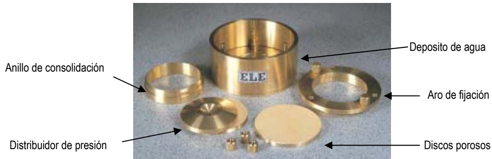
Figura 16.2 Consolidómetro de anillo fijo para la ejecución del ensayo de consolidación.
