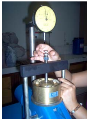
Figura 16.7 Colocación del marco de carga sobre el consolidómetro.
