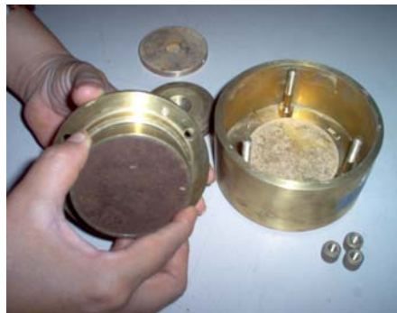
Figura 16.6 Colocación del espécimen en el consolidómetro.
