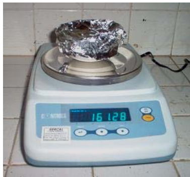
Figura 9.2 Determinación de la masa de suelo + recipiente de evaporación utilizando una balanza de 0.01 g de legibilidad.
