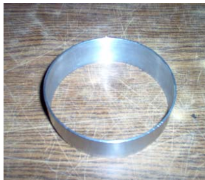
Figura 15.4 Anillo cortante para el labrado del espécimen en el ensayo de corte.
