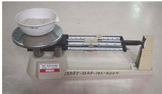
Figura 3.1 Pesado del recipiente y muestra de suelo húmeda en una balanza de 0.1 g de legibilidad.
