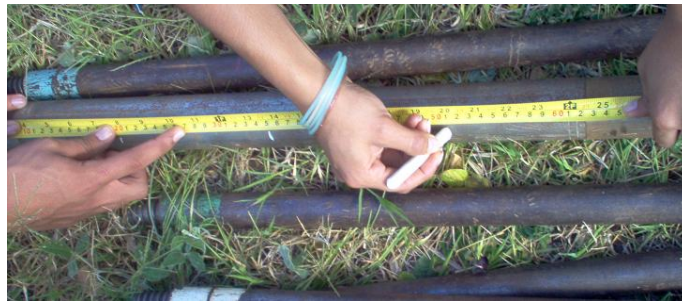
Figura 18.3 Marcación de las barras muestreadoras para realizar el ensayo de penetración estándar.
