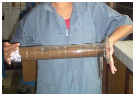
Figura 6.6 Agitado de la lechada.
