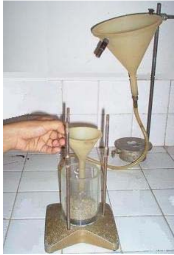
Figura 17.4 Colocación de la capa de suelo en el Permeámetro, utilizando un embudo en la realización del ensayo de permeabilidad.
