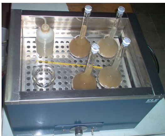
Figura 5.5 Colocación de los frascos volumétricos con la lecheada, beaker termómetro, piseta dentro del recipiente baño María.
