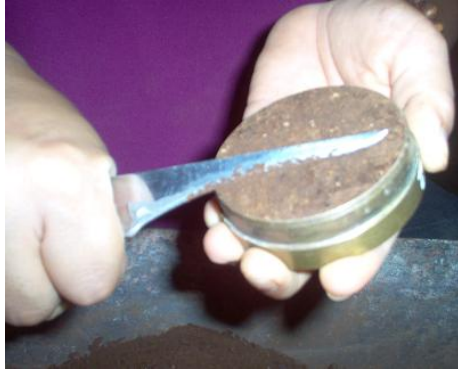
Figura 16.4 Corte de los bordes del espécimen para el ensayo de consolidación.
