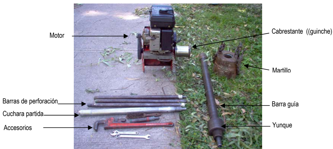
Figura 18.2 Equipo utilizado para la realización del ensayo SPT.
