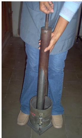
Figura 11.4 Compactación de la primera capa de suelo molde Proctor..
