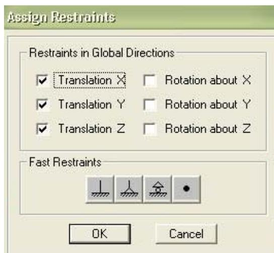
Figura 3.40. Asignación de apoyo ó soporte en la base de la estructura.
