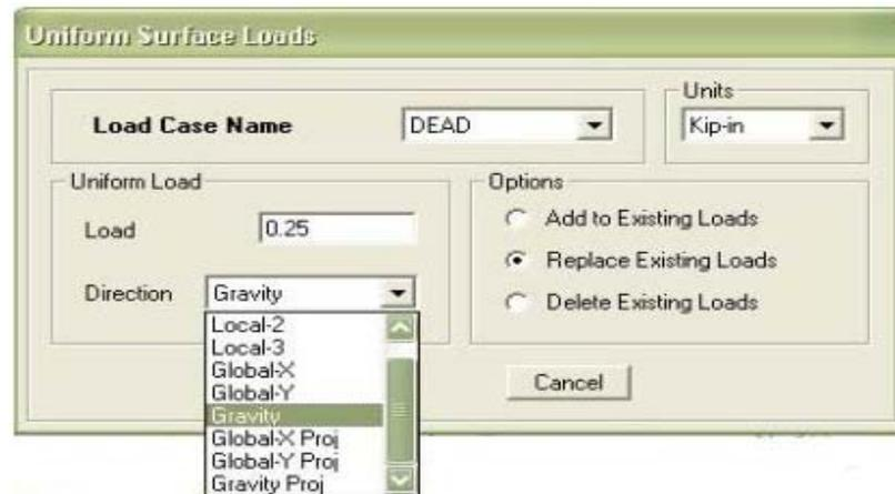
Figura 3.54. Asignación de la dirección de la carga aplicada (X, Y ó Z).
