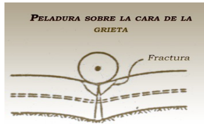
Figura 3.11. Peladura sobre la cara de la grieta. 85
