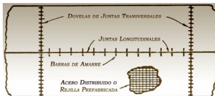
Figura 3.8. Acero y juntas en pavimentos de concreto. 81
