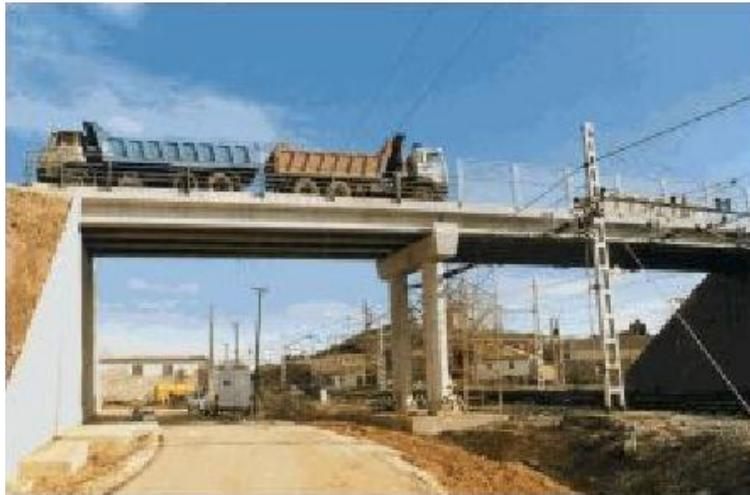
**Fig. 3.1. Ilustración de la ejecución de una prueba de carga estática.**
