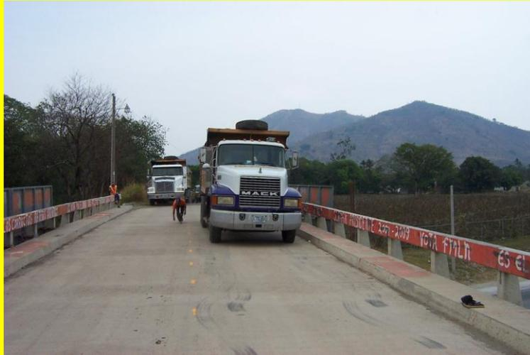
**Fig. 4.47. Primer escalón del primer ciclo de carga para el estado de carga ejecutado.**
