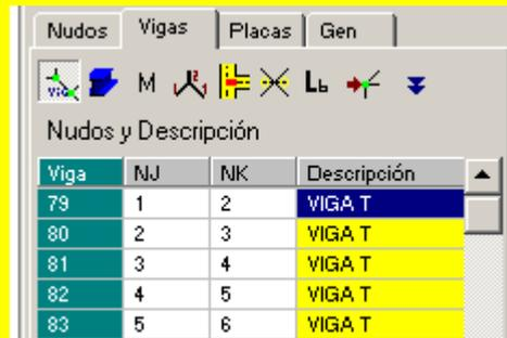
**Fig. 4.23** En la figura se muestra seleccionado el botón “conectividad y descripción” de la viñeta “vigas”. Adicionalmente, se presenta el llenado de la descripción de un grupo de elementos que, para el caso, se llama “VIGA T”.
