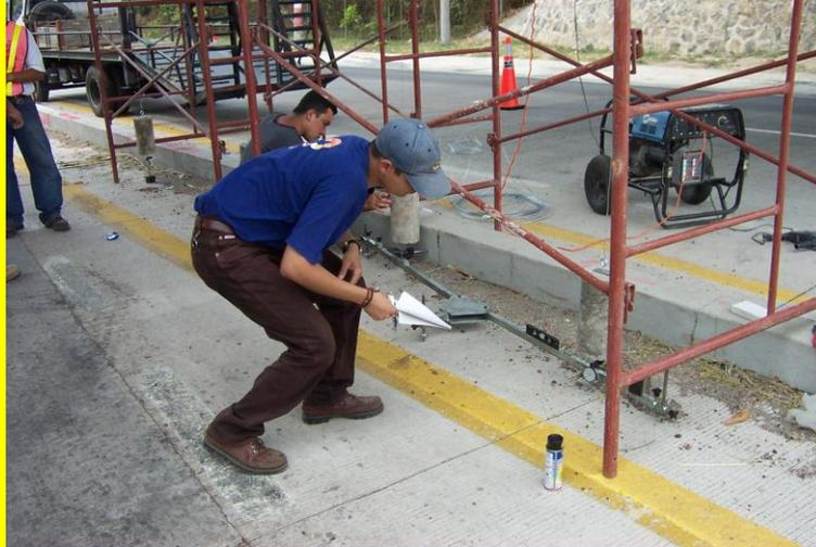
*Fig. 4.42. Instantes en que se tomaron lecturas de deformación. Se observa, en la figura, a las plomadas haciendo contacto con los deformímetros ubicados sobre los bastidores nivelados.*
