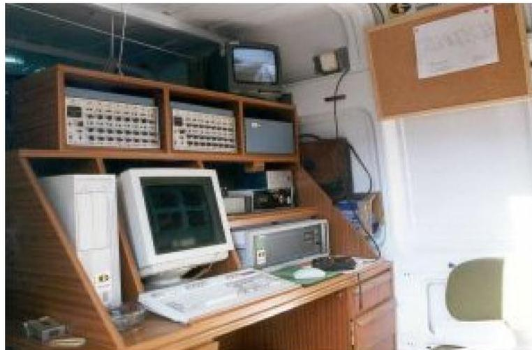
**Fig. 3.6. Equipo computarizado para la obtención y análisis de datos provenientes de la prueba de carga.**
