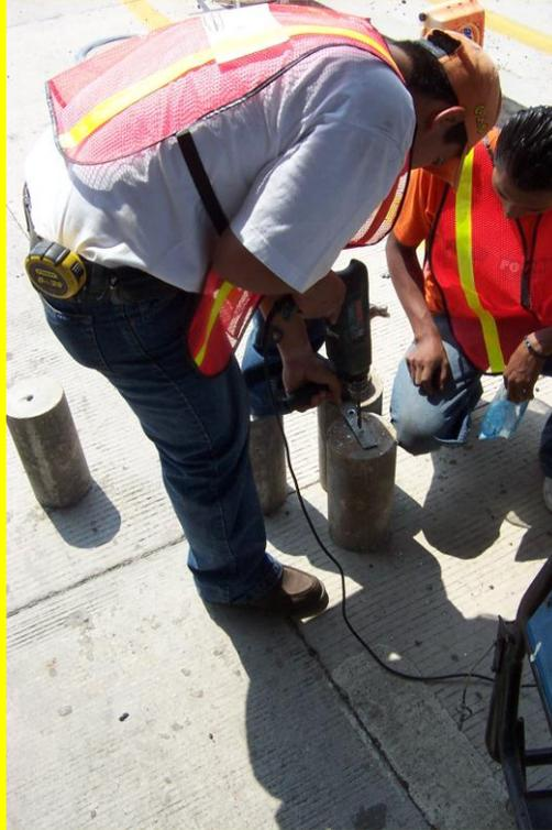
**Fig. 4.41. En la figura se observan los cilindros de concreto que fueron utilizados como plomadas durante la toma de lecturas en los deformímetros.**
