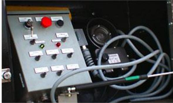
*Fig. 3.11. En la figura se presenta un sistema de comunicación, el cual se activa por voz desde la plataforma aérea hasta el control central ubicado en la cabina del camión.*
