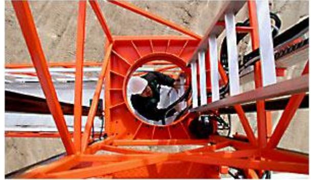
**Fig. 3.9.** Escalera de acceso a la plataforma aérea ubicada dentro de la torre para el acceso seguro del personal mientras la unidad está erigida y en operación.
