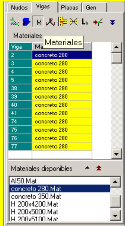
**Fig.4.25** En la figura se presenta seleccionado el botón “materiales” de la viñeta “vigas”. Adicionalmente, se muestra el llenado de la asignación del material “concreto 280” para un número determinado de elementos.
