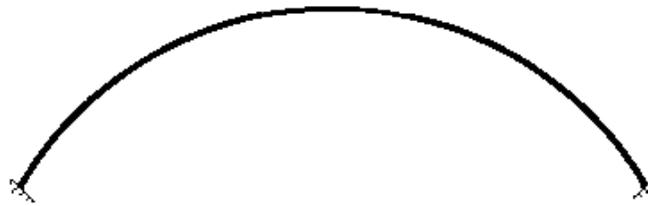
*Fig. 2.4. Esquema de arco empotrado.*
