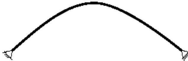
*Fig. 2.5. Esquema de arco biarticulado.*
