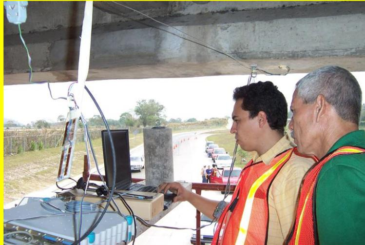
**Fig. 4.40. Uso de sistema computarizado para la adquisición y procesamiento de información (señales eléctricas) proveniente de las galgas extensométricas.**
