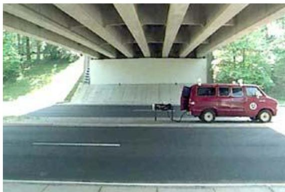
***Fig. 3.4. Uso de sistema láser en pruebas de carga.***
