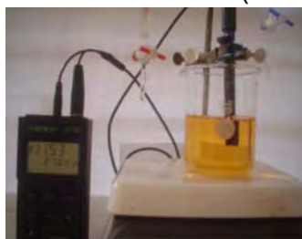
Fig.44 Preparación de solución Buffer de Fosfato de Sodio – Hidróxido de Sodio. A un pH de 12.0
