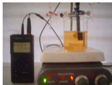
Fig.47 Preparación de solución Buffer de Hidróxido de Sodio – Cloruro de potasio. A un pH de 13.0
