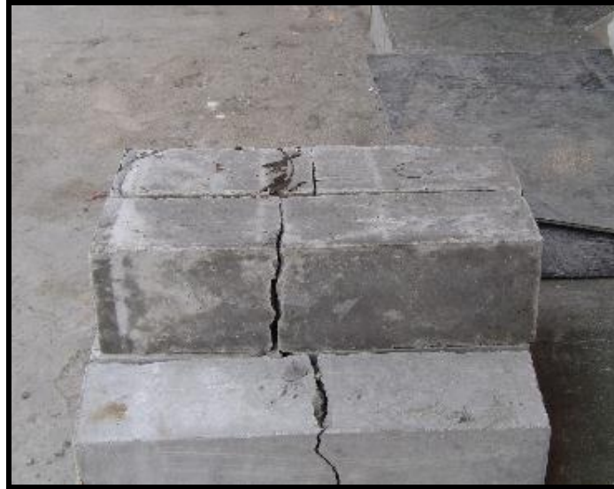
FIGURA 115: Falla observada en las viguetas sometidas al ensayo de flexión realizado al CAC.
