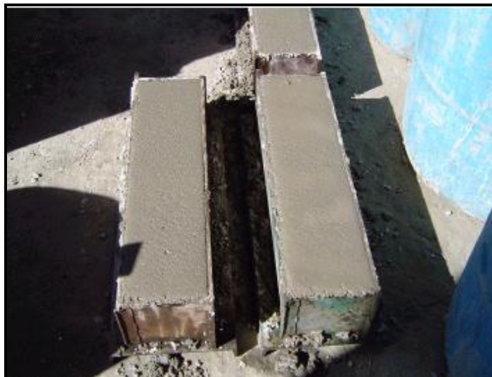
FIGURA 100: Muestras para los especímenes de prueba a flexión del CAC.
