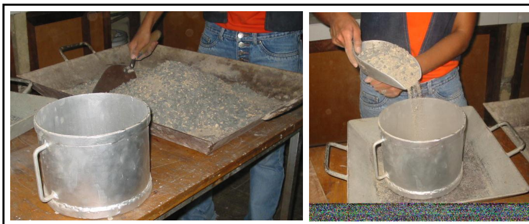
FIGURA 82: Proceso de mezclado y llenado de la grava y arena para el procedimiento experimental del esqueleto granular.
