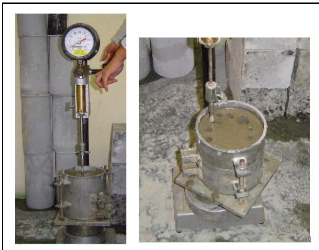
FIGURA 95: Equipo y prueba realizada en el ensayo de fraguado del CAC.
