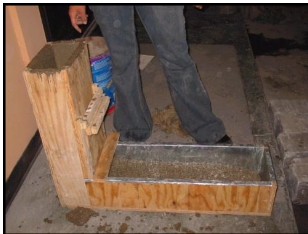
FIGURA 91: Ensayo de caja en L que se realizó al CAC.
