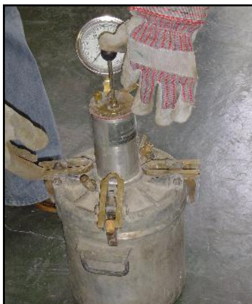
FIGURA 93: Equipo de presión utilizado en el ensayo para la determinación del contenido de aire del CAC.
