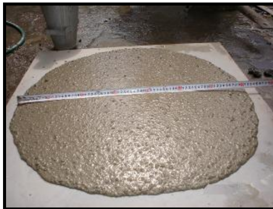
FIGURA 90: Fluidez del CAC en la mezcla B.
