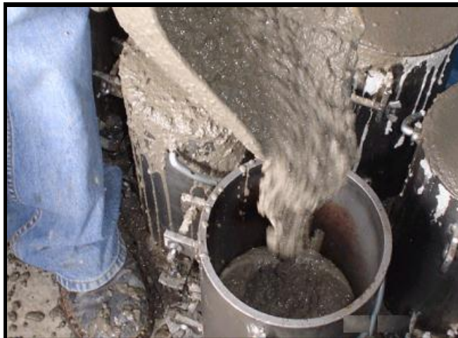
FIGURA 96: Vertido del concreto para elaborar los especímenes de prueba a compresión del CAC.
