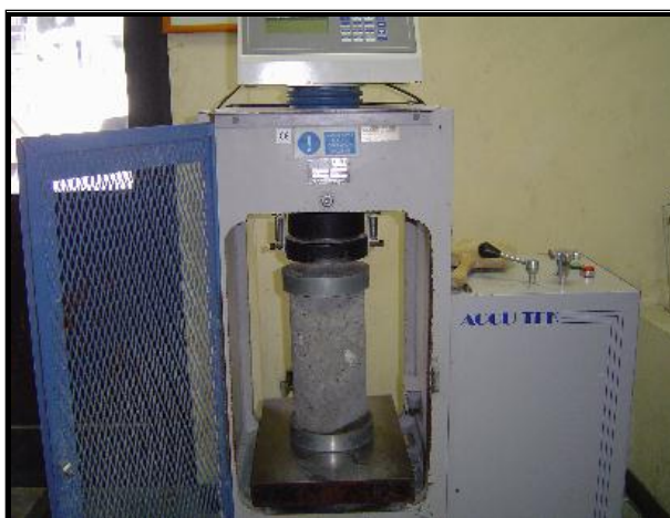
FIGURA 99: Ensayo a compresión realizado al CAC, y cabeceo.
