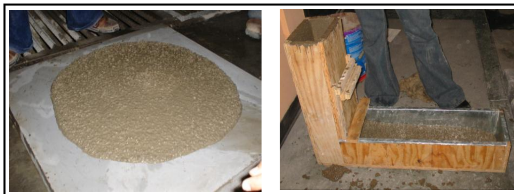
FIGURA 88: Ensayo de Cono Abrahams y Caja en L, para CAC.
