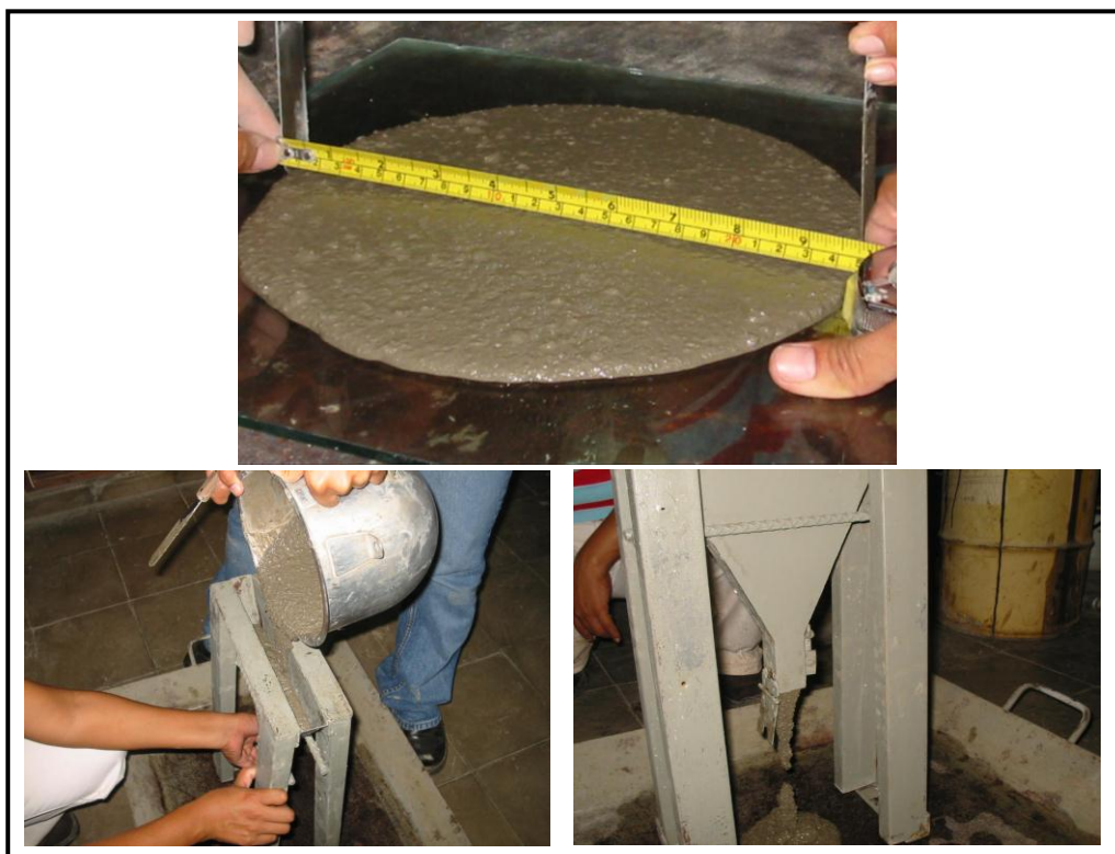
FIGURA 86: Ensayo de fluidez y proceso de llenado y apertura del embudo en V.
