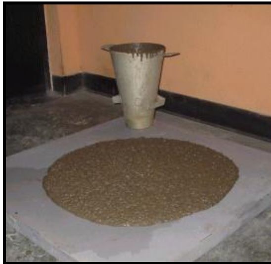
FIGURA 89: Fluidez del CAC en la mezcla A.
