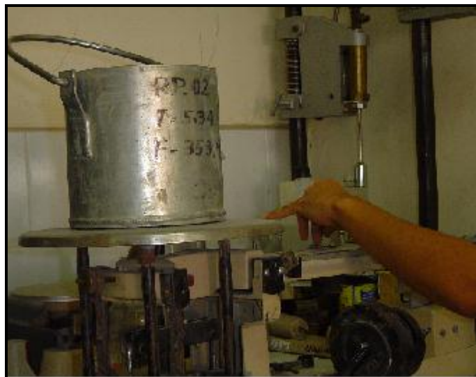
FIGURA 94: Equipo utilizado en el ensayo del peso unitario del CAC.
