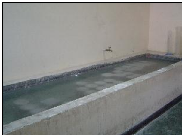
FIGURA 98: Pila de curado utilizada para los especímenes de prueba.
