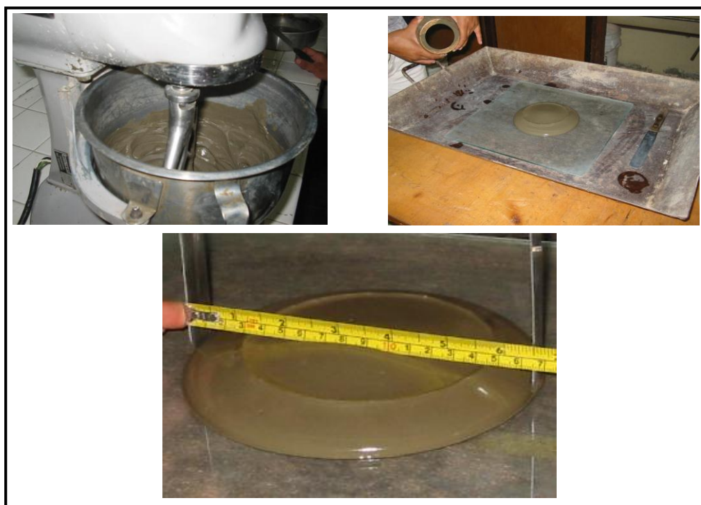
FIGURA 83: Proceso de mezclado y lectura de la extensión de la pasta.
