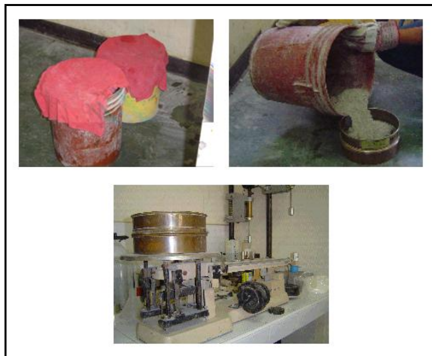
FIGURA 92: Sucesión de pasos en el ensayo de estabilidad del Tamiz GTM que se realizó al CAC.
