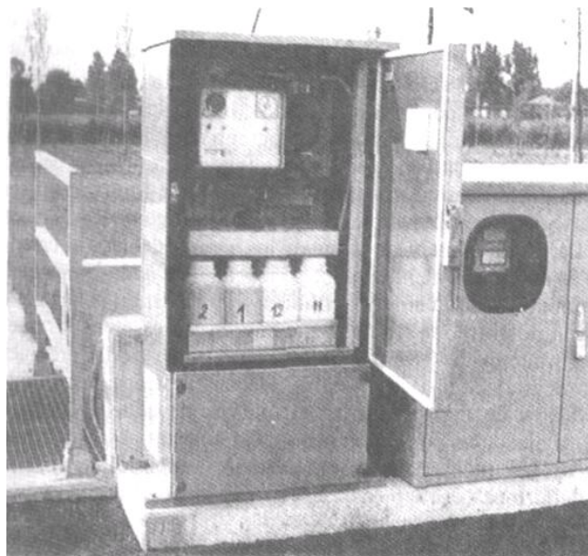
FIGURA 4. Dispositivo toma muestras típico empleado en plantas de tratamiento de aguas residuales.
