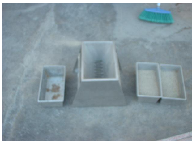
FOTO N° 3.2 Cuarteo de Agregado Fino.
