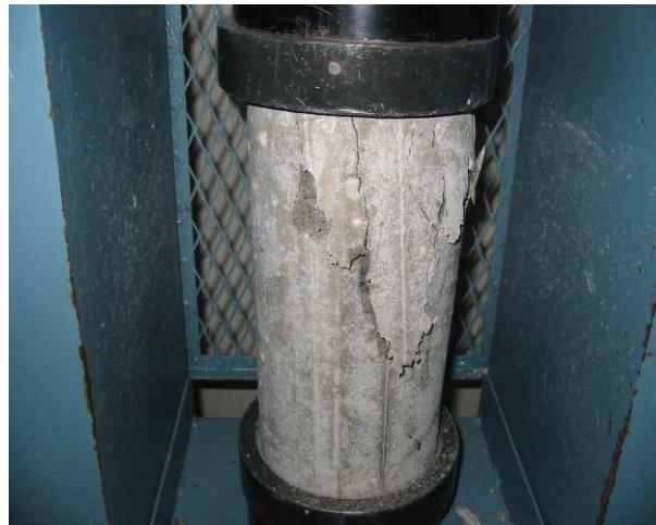
FOTO N° 3.7 Especímen en Prueba de Resistencia a la Compresión
