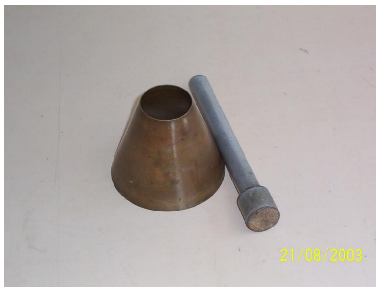
FOTO N° 3.4 Equipo para Absorción de arena.
