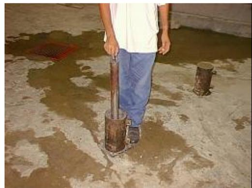
Fig. 3.5: Medición de la cantidad de agua y equipo de compactación
