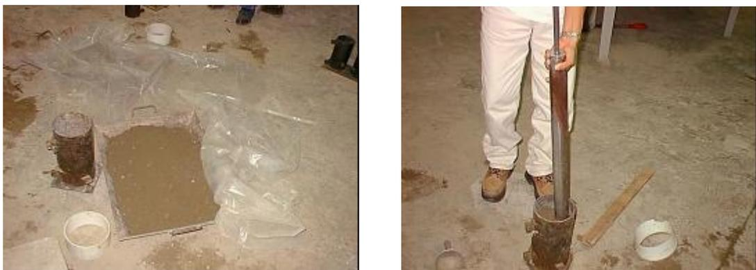
Fig. 3.8: Mezcla lista para ser compactada y proceso de compactación
