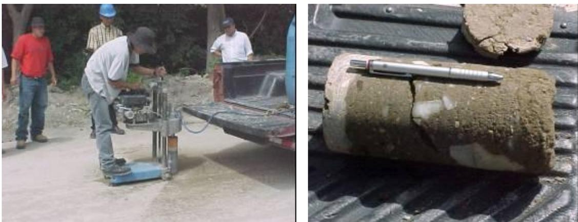
Fig. 3.34: Equipo de extracción de núcleos y especímen fracturado.
