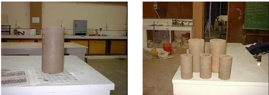
Fig. 3.10: Especímenes listos para ser llevados al cuarto húmedo
