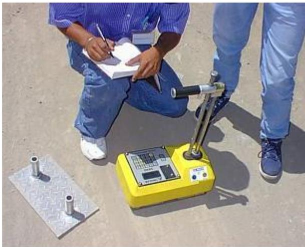
Fig. 3.16: Densímetro Nuclear en labores de verificación de las características del suelo en estado natural.
