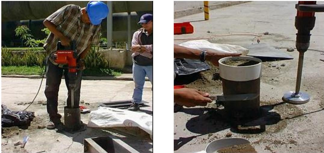
Fig. 3.11: Elaboración de especímenes cilíndricos con martillo vibro – compactador
