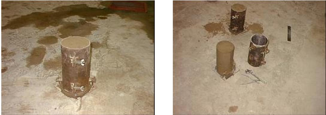
Fig. 3.9: Especimen compactado y desmoldado
