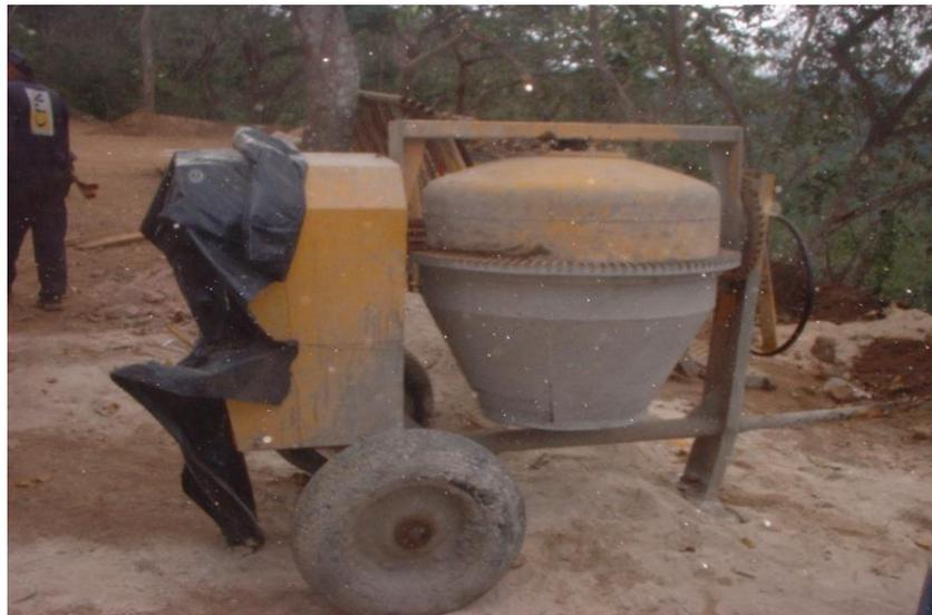
*Fig. 4.2 Mezcladora de una bolsa para volúmenes pequeños de RFRC elaborados en campo.*
