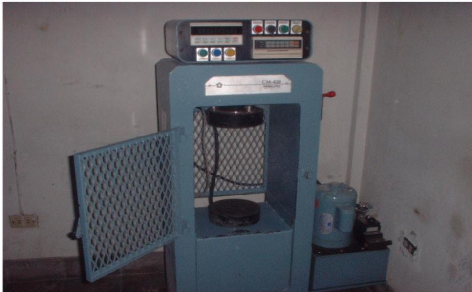
*Fig. 2.3 Máquina empleada para ruptura de cilindros probados a compresión.
