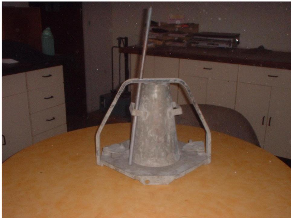
*Fig. 2.1, Equipo para toma de revenimiento (Cono de Abrams)*
