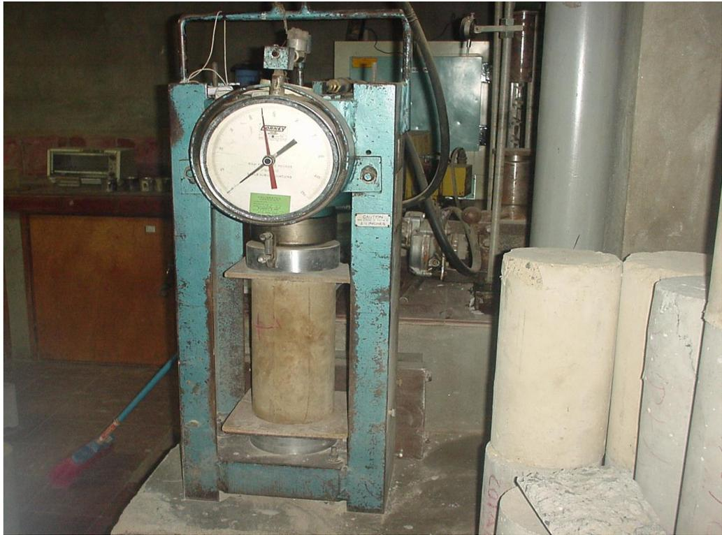
*Fig. 2.4 Máquina empleada para ruptura de cilindros probados a compresión.
