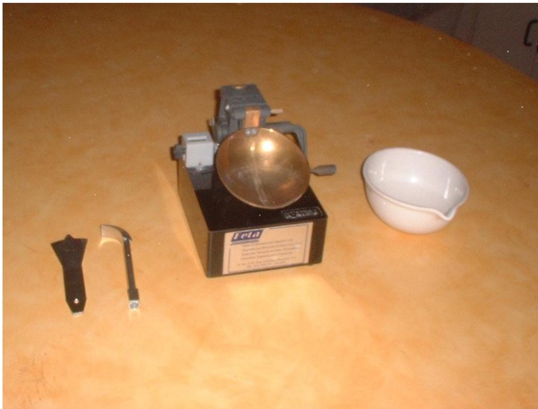
*Fig. 3.2 Equipo para obtener los límites de consistencia (Atterberg)*
