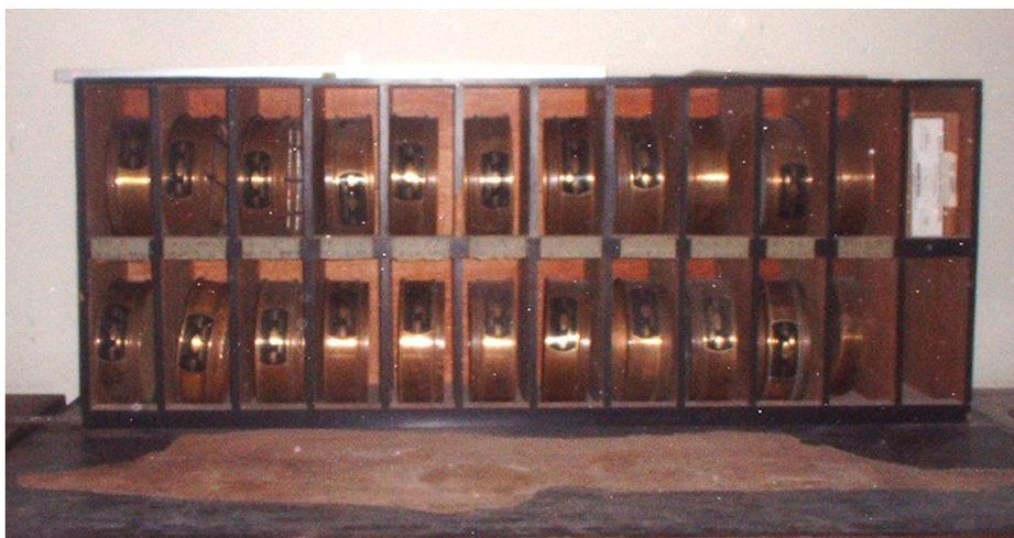
*Fig. 3.1 Juego de mallas empleado para el análisis granulométrico de los suelos.*
