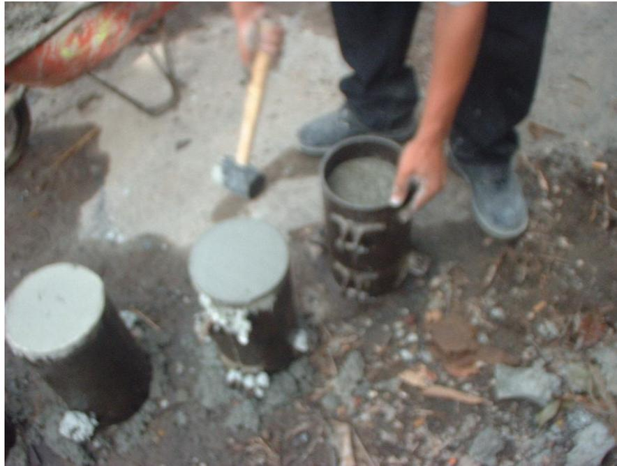
*Fig. 2.10 Aplicación de golpes con almódana de hule para liberación de aire atrapado.*
