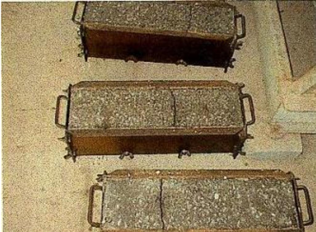
*Fig.3.3 Agrietamiento en especímenes (viguetas) de suelo cemento.*
