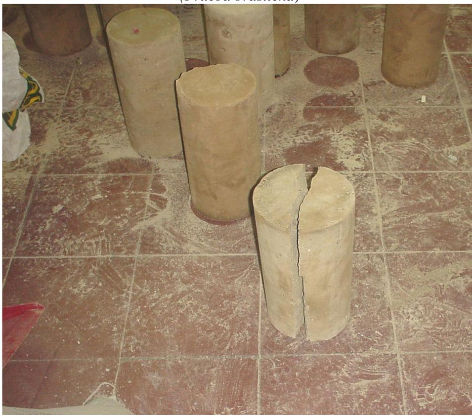
*Fig.2.15 falla típica de los cilindros probados a tensión (prueba brasileña)*
