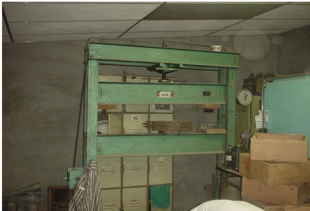
*Fig. 2.13 Máquina empleada para prueba a tensión de los cilindros (Laboratorio FC)*
