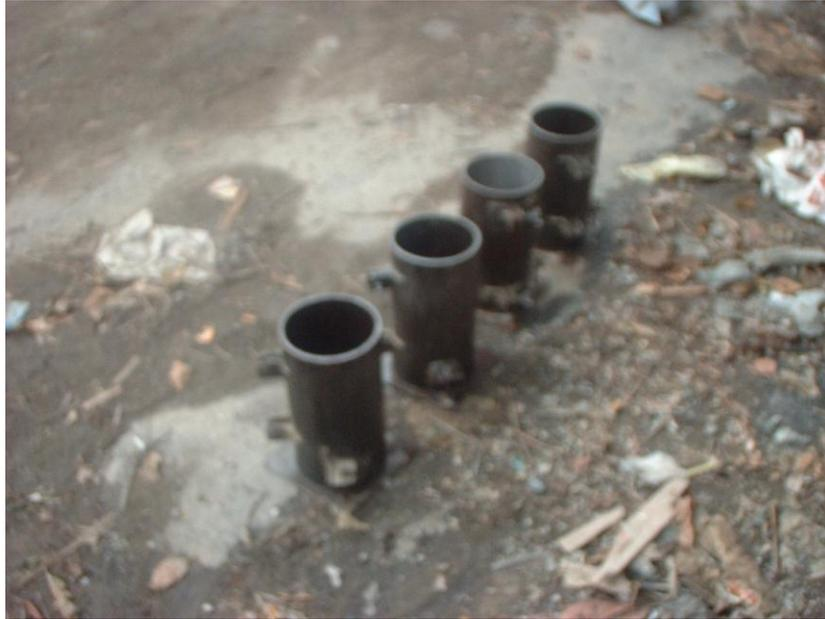
*Fig. 2.8 Moldes empleados para la obtención de muestras.*
