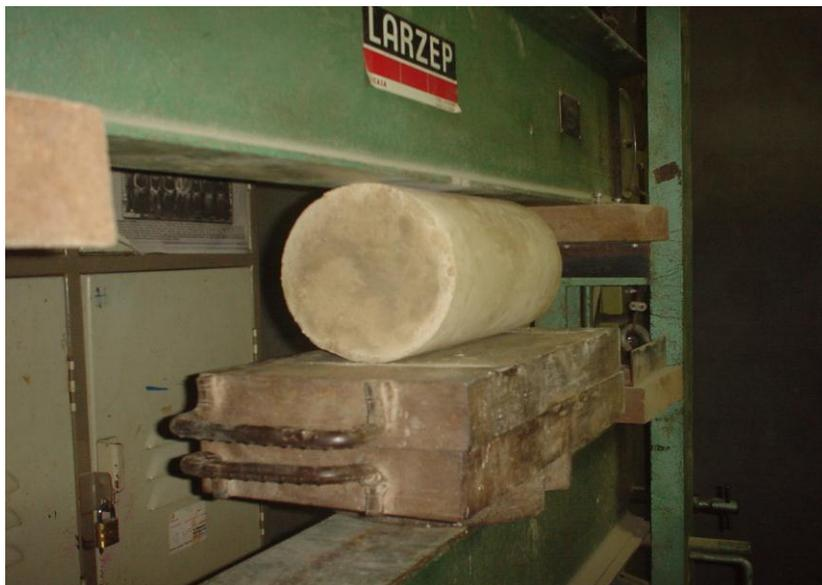
*Fig.2.14 Forma de colocación de los cilindros probados a tensión (Prueba brasileña)*
