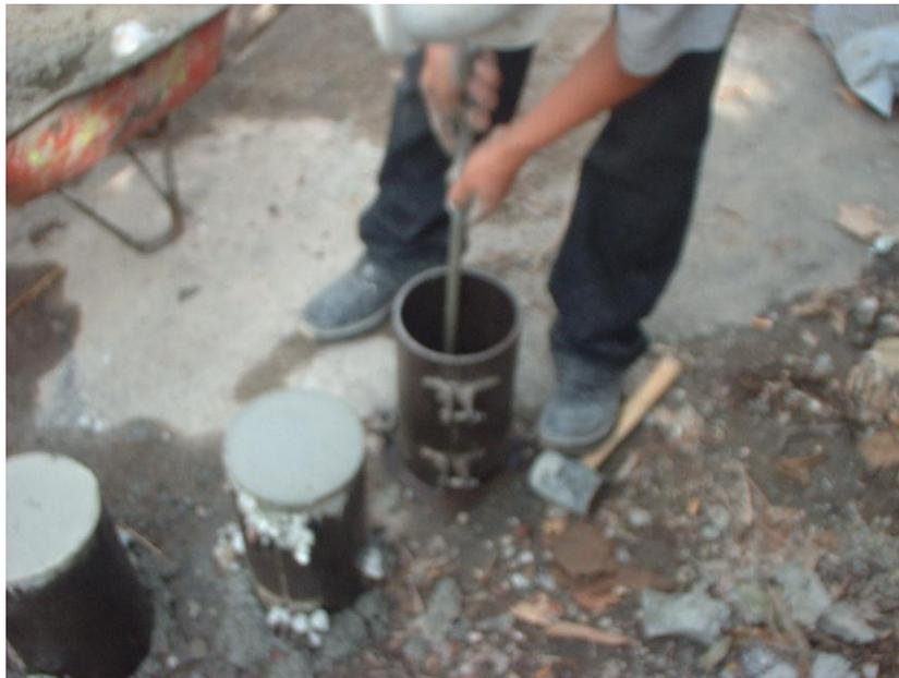
*Fig. 2.9 Proceso de llenado de los moldes testigos*
