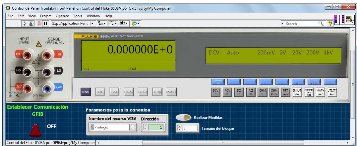
Figura 3.1 Control frontal del multímetro patrón hecho en LabVIEW.
