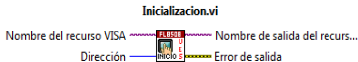
Figura B.1. SubVI para configurar al controlador Prologix GPIB-USB.
