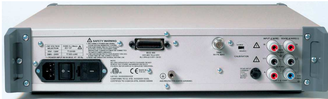
Figura 2.8. Detalles del panel posterior del 8508A.
