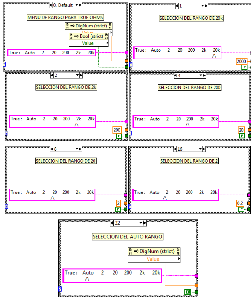
Figura 3.56. Casos para la selección del rango del menú TRUE OHMS.
