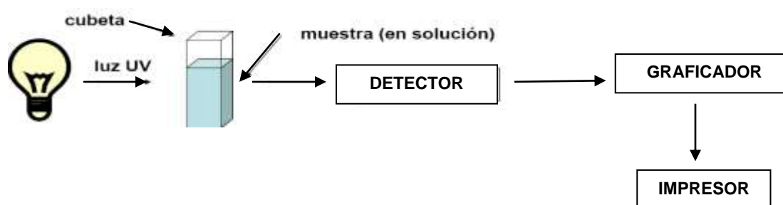
Figura No.16: Esquema de absorción de muestra en el espectrofotómetro UV- VIS
