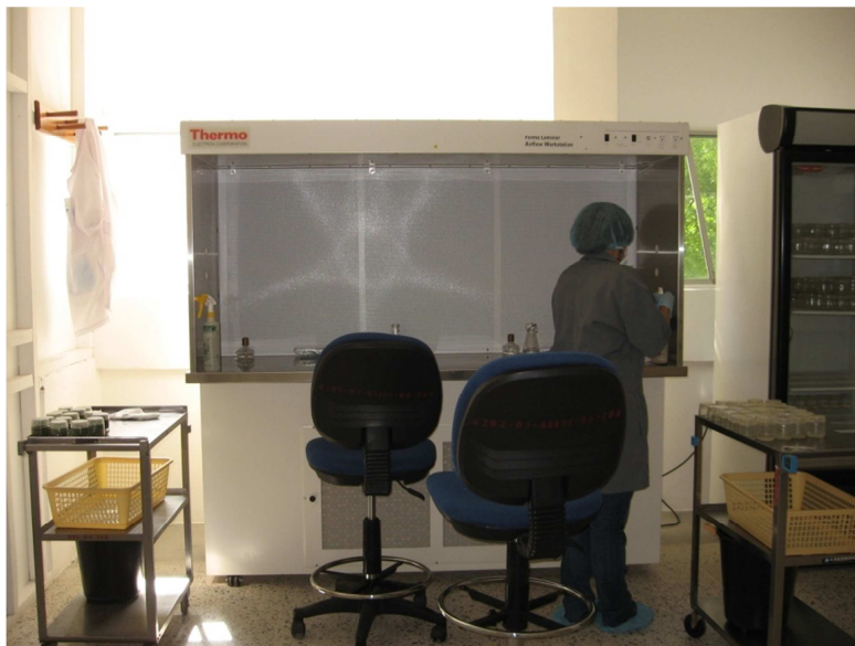
Figura A-10. Cámara de flujo laminar.
