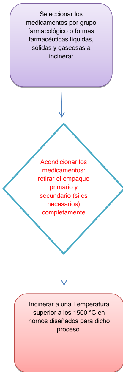
Figura N° 15: Procedimiento propuesto para incineración a 1500 °C.
