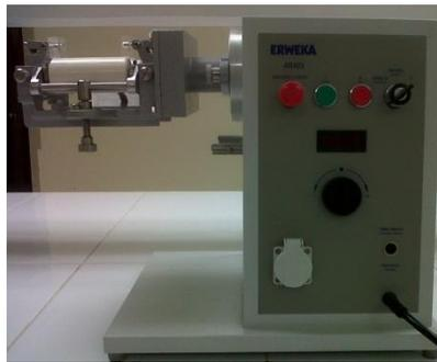
Fig. N° 1 Motor Universal Erweka AR403, tiene adaptado el molino de 3 rodillos
