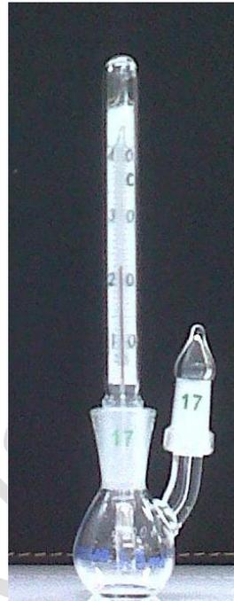
Fig. N° 27 Picnómetro ISOLAB de capacidad 5 mL
