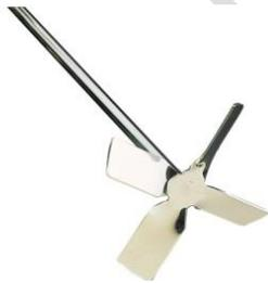
Fig. N° 37 Varilla agitadora de 4 hélices
