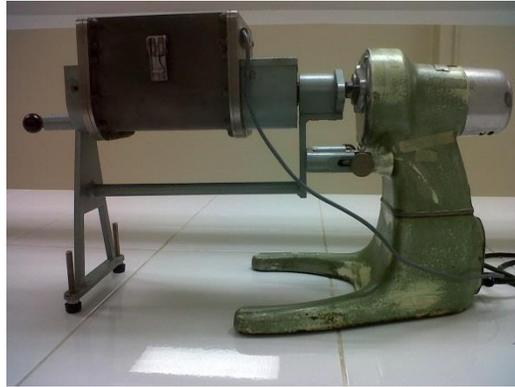
Fig. N° 5 Motor Universal Erweka KU1, tiene adaptado su mezclador amasador Erweka LK5
