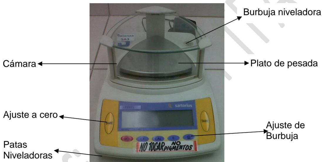
Fig. N° 22 Esquema de Balanza Sartorius
