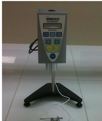
Fig. N° 43 Viscosímetro Brookfield DV-I
