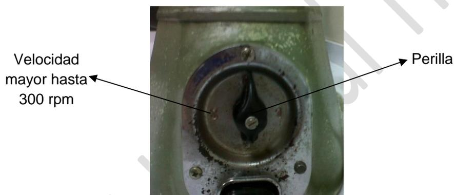
Fig. N° 9 Mando de control del Motor Universal Erweka Ku1
