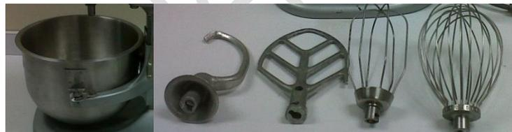
Fig. N° 40 Accesorios del mezclador de semisólidos HOBART, en el orden que aparecen de izquierda a derecha recipiente de acero Stanless, gancho de la pasta, batidor plano.
