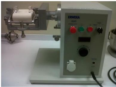
Fig. N° 33. Molino de 3 Rodillos Erweka tipo SM conectado al Motor Universal AR 403
