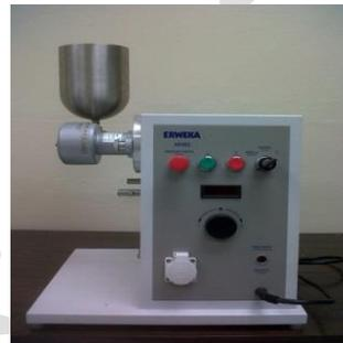
Fig. N° 34 Homogenizador Erweka tipo HO conectado al Motor Universal AR 403
