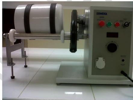
Fig. N° 35. Molino de Bolas Erweka tipo KMS conectado al Motor Universal AR 403
