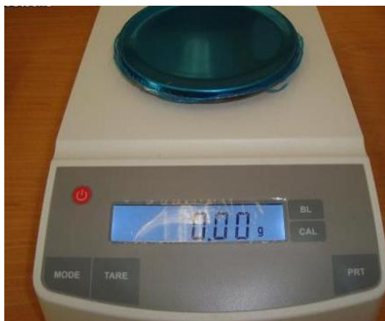
Figura No 15 Balanza semianalítica, Marca Mettler Toledo, Modelo AN-7, se utilizó en la preparación de los medios microbiológicos
