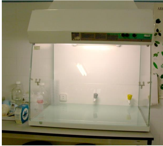
Figura No 17 Cámara de Flujo Laminar Marca CLIMAR SF 524R, Modelo 45CO74-PL, utilizado para la preparación y siembra de las pruebas microbiológicas
