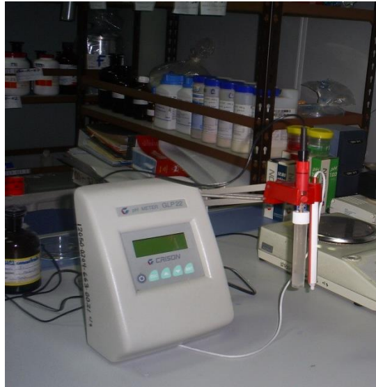
Figura No 19 pH-metro marca CRISON GLP 22, se utilizó para la medición del pH de la muestra del Producto Innovador y el Producto Nacional
