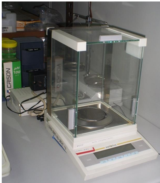
Figura No 14 Balanza Analítica, Marca Mettler Toledo, Modelo PCEs-L741, se utilizó para la prueba de densidad y la prueba del ensayo del Producto Innovador y Producto Nacional
