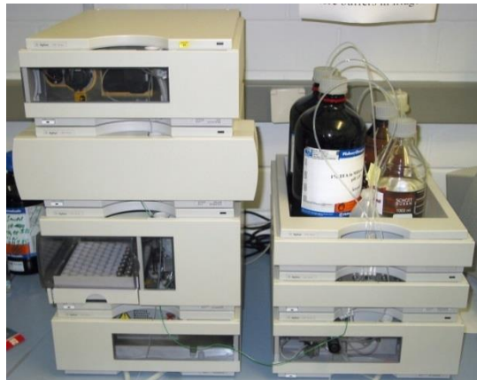
Figura No 17 Cromatografo HPLC, Marca Perkin Elmer, Modelo 200C, utilizado para la Prueba de Identificación y el Ensayo del Producto Nacional y Producto Innovador
