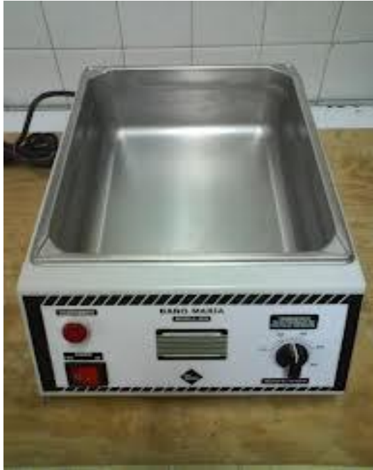
Figura No 16 Baño de agua calibrado a 37°C, Marca Electrolabs, Modelo 78-543-1, utilizado para la incubación de la prueba de endotoxinas
