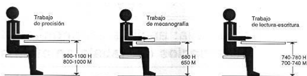
Figura N° 90. Altura de las mesas de trabajo para puestos de trabajo en oficinas
