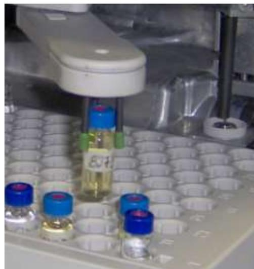
Fig. N° 14. Proceso de Inyección de cada una de las muestras en el Equipo HPLC.
