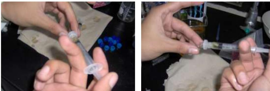
Fig. N° 11. Proceso de Filtración e Inyección de cada una de las muestras en los tubos receptores.
