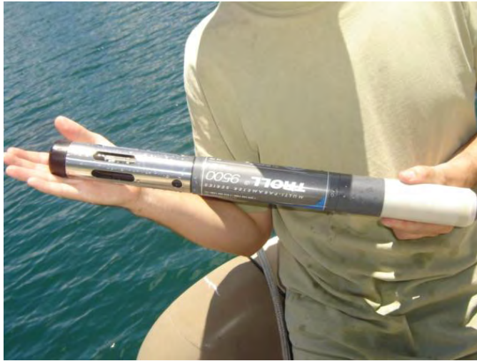
FIGURA N°9 Sonda del aparato IN-SITU TROLL 9000 que se introduce dentro del lago para determinar parámetros en campo.
