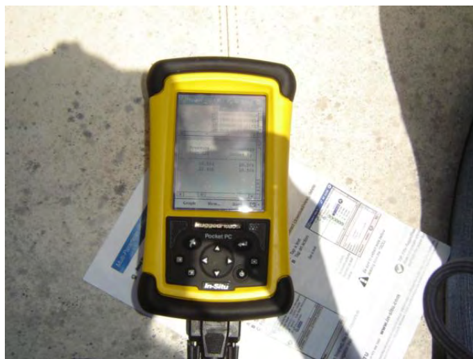
FIGURA N°8 Aparato IN-SITU TROLL 9000 para análisis de parámetros en campo.
