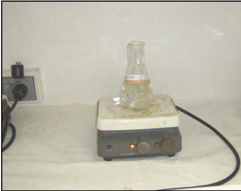
Figura No. 36: Hot Plate con agitador magnético Corning modelo PC-320
