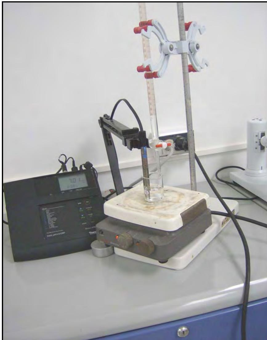
Figura No. 35: pHmetro Termo Orión modelo 420 A+
