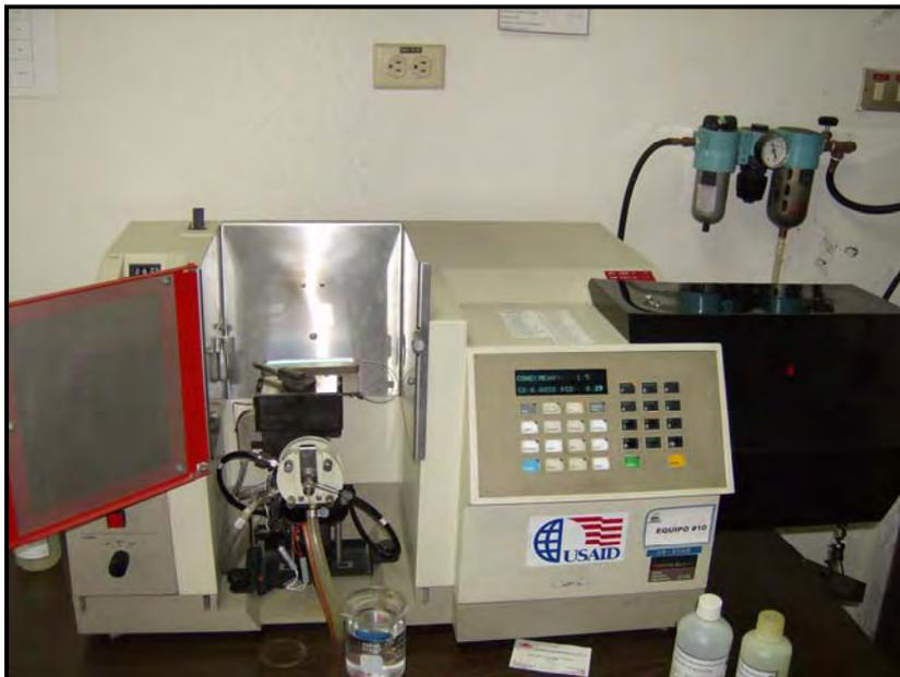
Figura No.37 espectrofotómetro de Absorción atómica Perkin Elmer 3110
