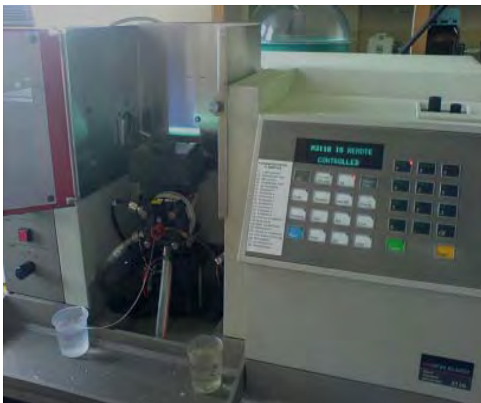
Figura N° 31. Espectrofotómetro de Absorción Atómica Perkin Elmer 3110
