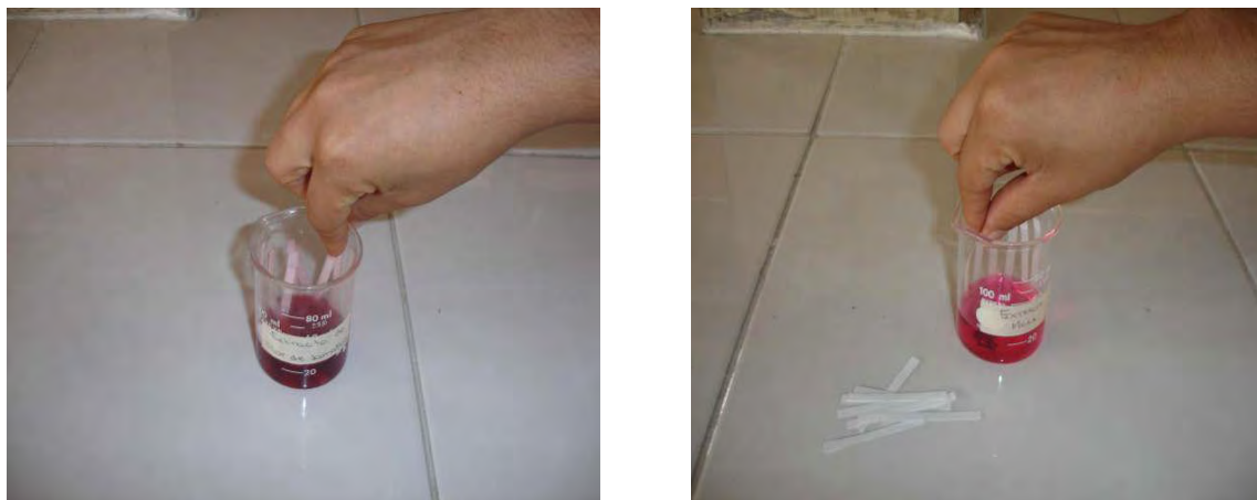
Figura No. 12. Proceso de elaboración de papel indicador a partir del extracto etanólico levemente acidificado de Hibiscus sabdariffa (Flor de Jamaica) y Rubus fruticosus (Mora).
