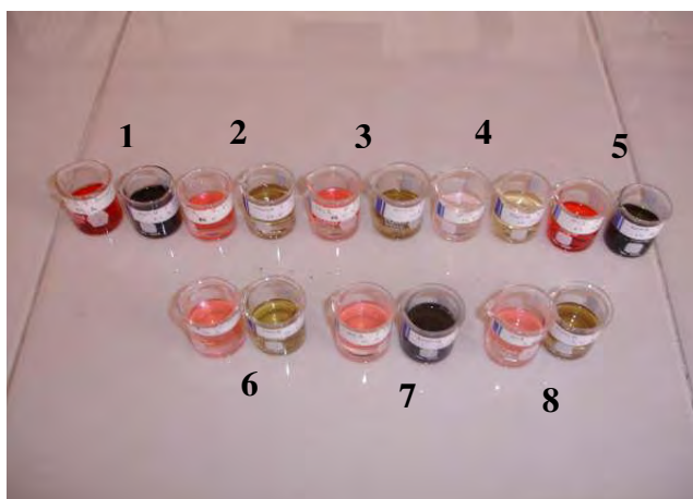
Figura No. 23. Viraje e intensidad de color de Hibiscus sabdariffa (Flor de Jamaica) ante HCl 0.1 M e NaOH 0.1 M.
