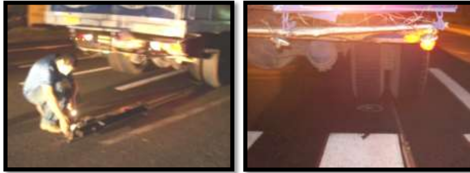
Figura 3.10.-Colocación de la Viga Benkelman entre las dos ruedas.
