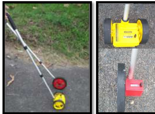
Figura 3.06.-Odometro manual para medir las longitudes y las áreas de los deterioros
