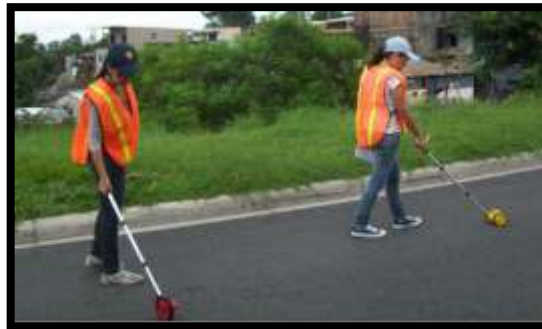
Figura 3.05.-Personal necesario para la realización del relevamiento de deterioros
