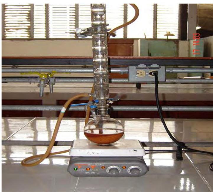
Fig. N° 22 Extracción con Alcohol
