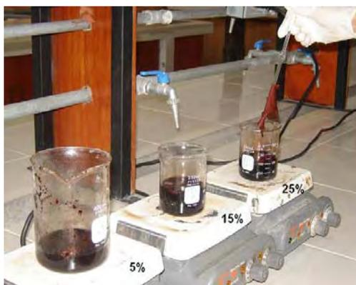
Fig. N° 39 Fijación del color en la fibra
