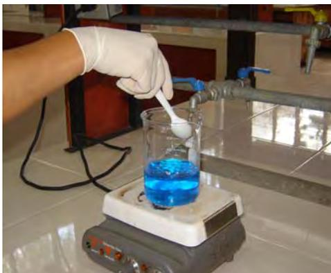
Fig. N° 32 Preparación de la solución saturada de  $\text{CuSO}_4 \cdot 5\text{H}_2\text{O}$
