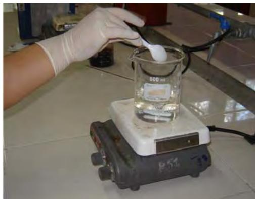
Fig. N° 33 Preparación de la solución saturada de  $\text{Na}_2\text{SO}_4$
