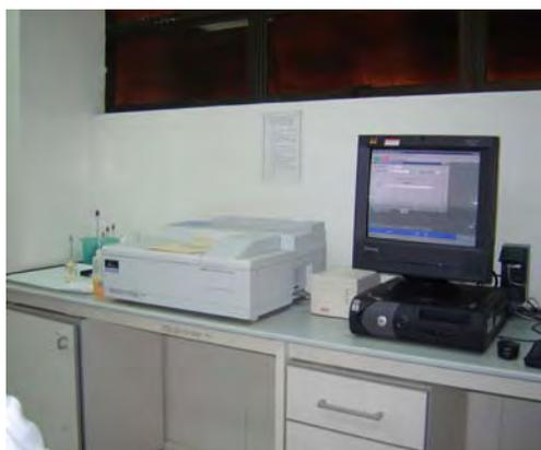
Fig. N° 30 Espectrofotómetro UV-VIS Lambda 35
