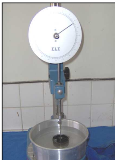
FIGURA 3.8 Ensayo de penetracion en muestras de asfalto.
