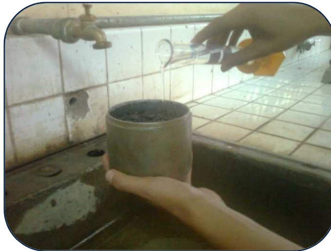
FIGURA 4.14 “Prueba” de permeabilidad, de acuerdo a criterios de normativa INVIAS
