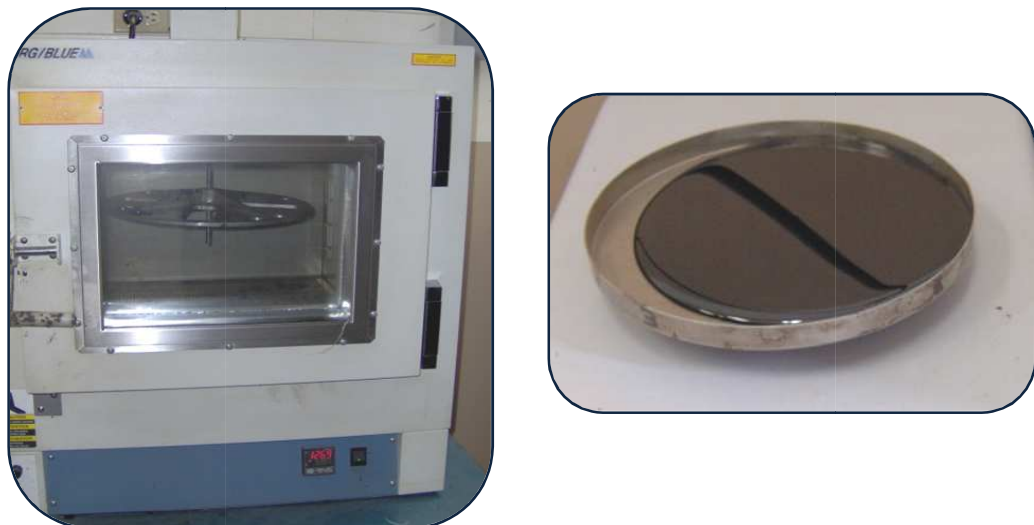
FIGURA 3.10 Horno para ensayo de película delgada y muestra de ensayo
