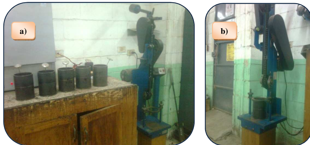
FIGURA 4.9 Proceso de compactación a) Briquetas a compactar b) Compactación
