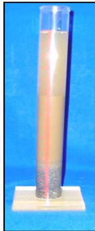
FIGURA 3.6 Probeta graduada con material listo para reposar durante el ensayo del equivalente de arena
