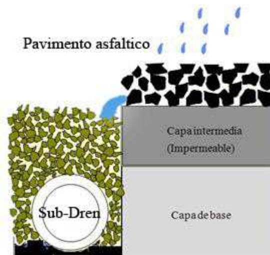
FIGURA 2.1. Esquema del funcionamiento de una capa drenante.
