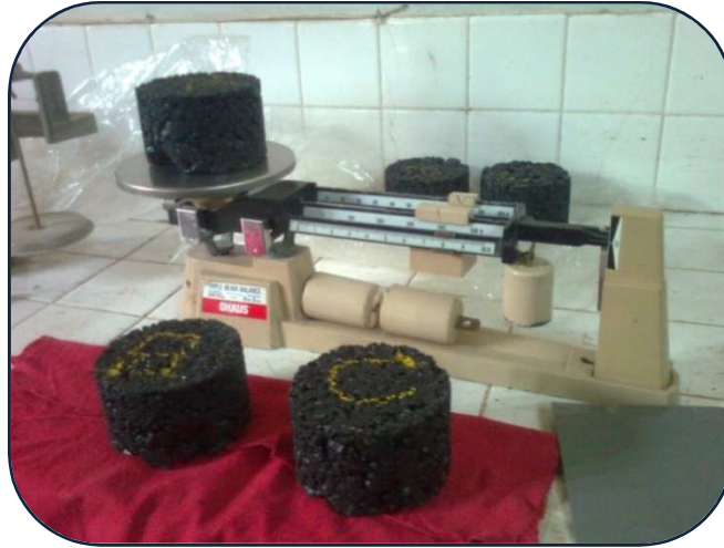
FIGURA 4.11 Toma del peso de la briqueta antes del ensayo
