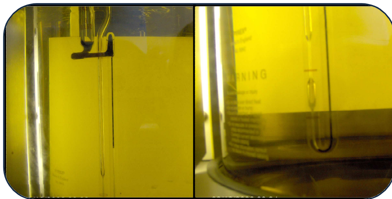
Fuente: tesis "Guía Básica de diseño, control de producción y colocación de mezclas asfálticas en caliente", UES 2007 FIGURA 3.9 Flujo de asfalto a través de viscosímetro para ensayo de viscosidad cinemática
