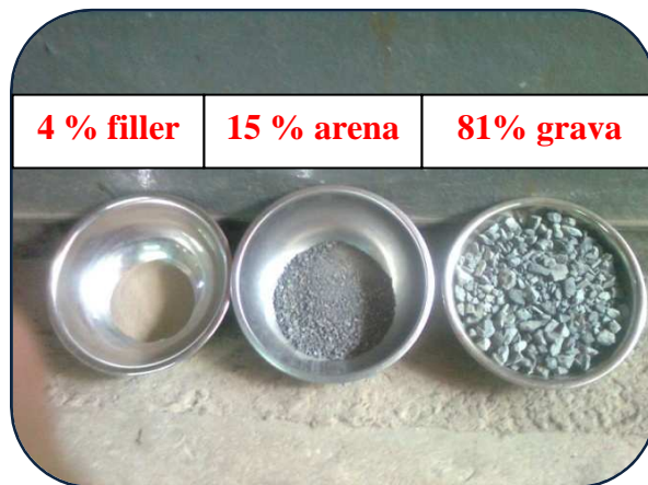
FIGURA 4.4 Proporcionamiento de agregados
