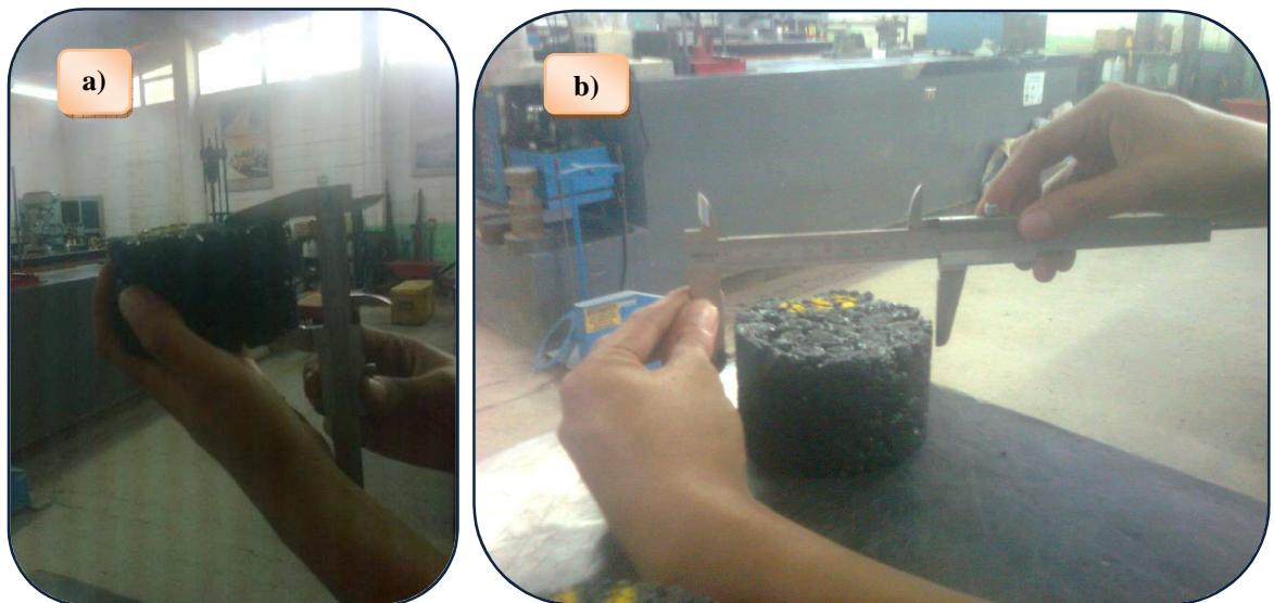
FIGURA 4.10 Toma de mediciones a) Altura b) Diámetro
