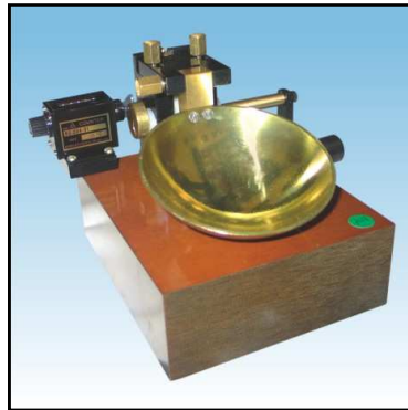
FIGURA 3.5 Copa de Casagrande para la medición del límite líquido
