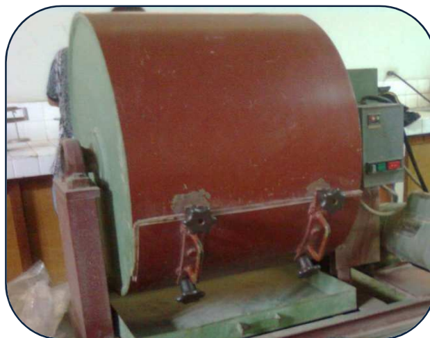
FIGURA 4.12 Máquina de los Angeles empleada en ensayo Cantabro
