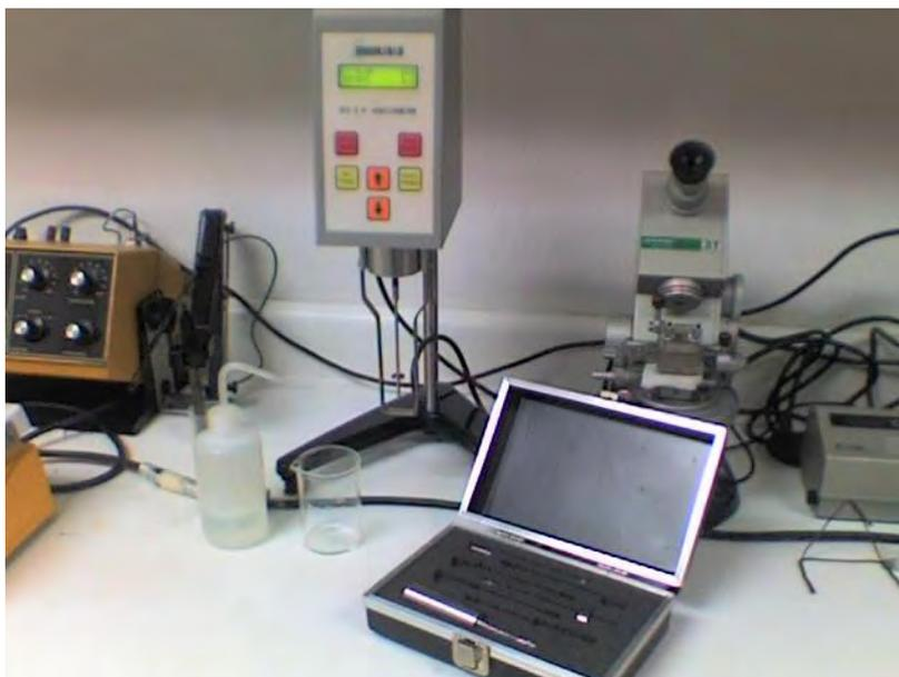
Figura 16. Viscosimetro de BROOKFIELD
