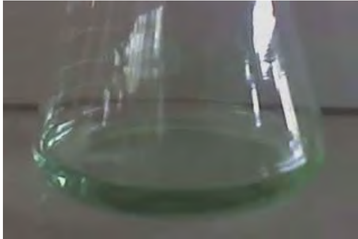
Figura N° 17. Resultado de la valoración con \text{KMnO}_4 0.005 N V.S. por el Método Volumétrico de Lowenthal (27).
