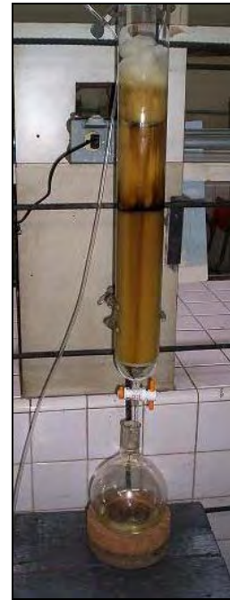
Figura № 59 Elución de fracción acetato de etilo puro.
