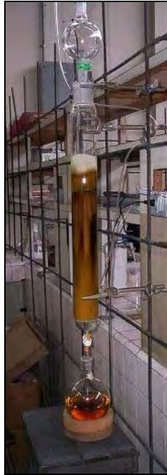
Figura № 58 Elución de fracción n -hexano:acetato de etilo 70%.
