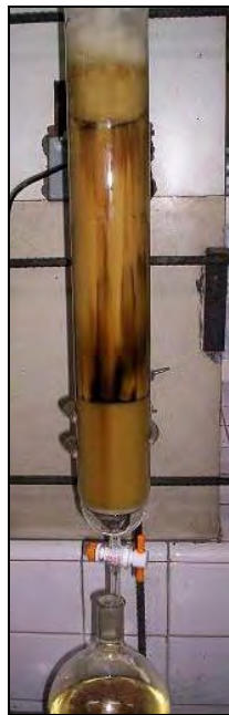
Figura № 60 Elución de fracción metanol puro
