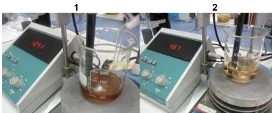
Fig. N°49: Valoración ácido fuerte-base fuerte con extracto de *Ixora coccínea* antes del punto final (1) y después del punto final (2)
