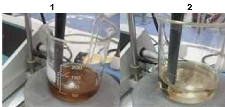
Fig. N°50: Valoración ácido débil-base fuerte con extracto de *Ixora coccínea* antes del punto final (1) y después del punto final (2)
