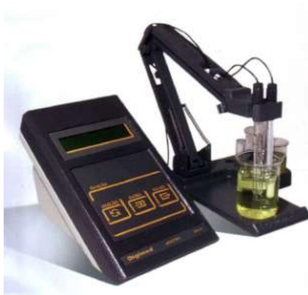
Fig. N° 8 pH-metro con un electrodo combinado. <sup>(24)</sup>
