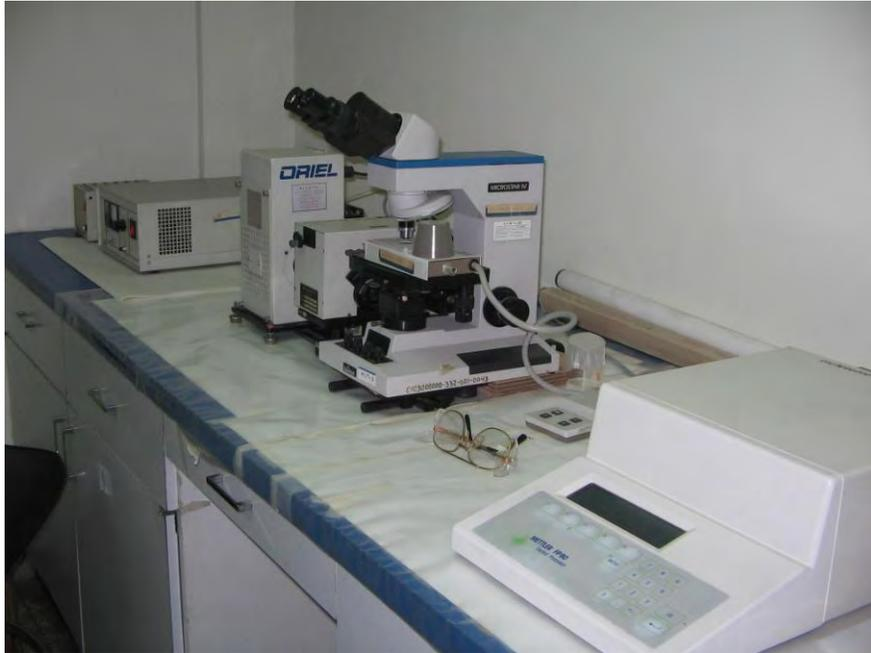
Figura No. 7: Equipo utilizado para la determinación de temperaturas de equilibrio.
