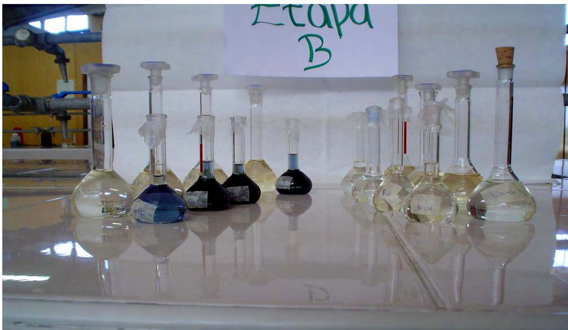
Fig. 11 Muestras con solución de vainillina en medio ácido y solución de tungsto-fosfomolibdico.
