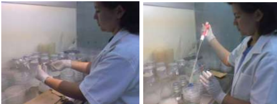
Fig. No 7: Preparación de muestras en diluciones decimales bajo la campana de flujo laminar.
