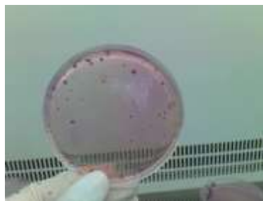
Fig. No 10: Placa de VRBA con crecimiento de coliformes a simple vista.
