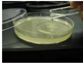
Fig No 3: Vertido en placa de agar Plate Count.
