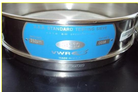
**Figura 2.27.** Especificaciones de los tamices usados para la extracción
