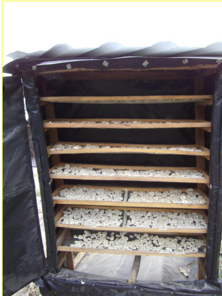
**Figura 2.20.** Colocación de bandejas con Guineo en secador solar
