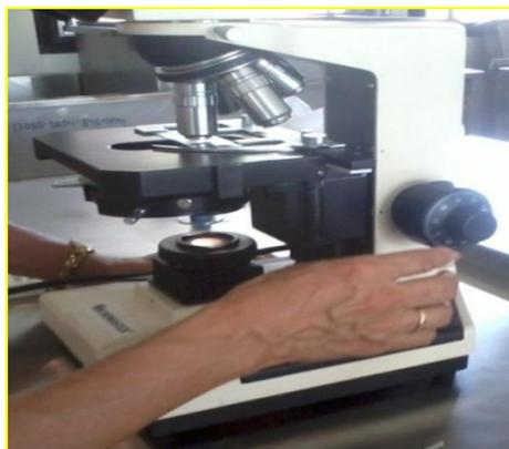
**Figura 3.4.** Uso del microscopio para verificar la forma del granulo
