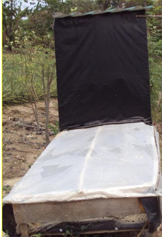
**Figura 2.18.** Secador solar de bandejas
