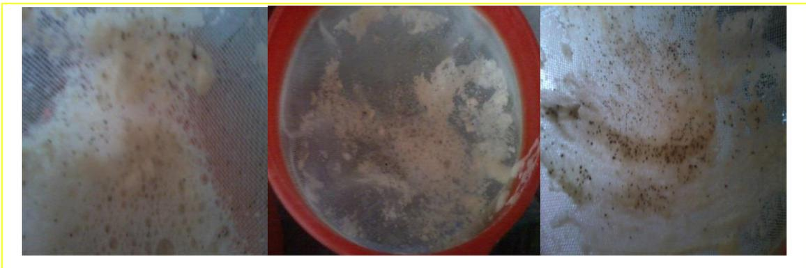
**Figura 2.34. Residuos de mezcla en el tamiz**
