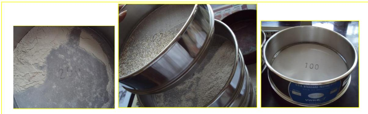
**Figura 2.26.** Mallas utilizadas para la operación de tamizado
