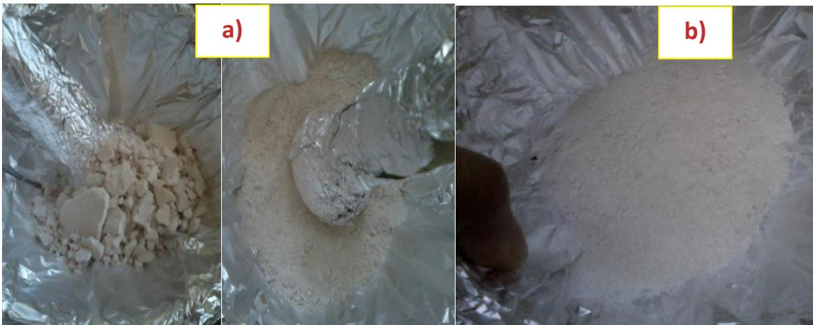
**Figura 2.40. a)** Partículas de tamaño mayor que se lleva a trituration y **b)** Partículas más finas después de la trituration.
