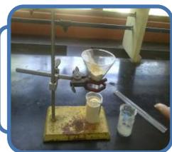
En una superficie libre de vibraciones montar el equipo mostrado en la figura; midiendo 25mm de altura entre embudo y beaker
