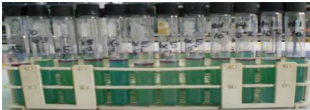
Figura N° 8: Prueba confirmativa con reactivo de Kovac para identificación de E. coli .
