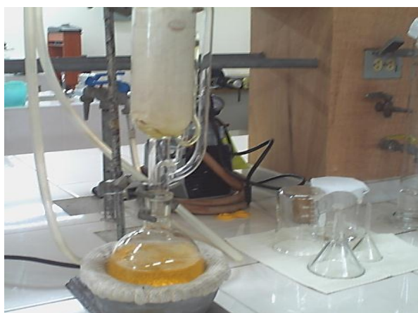
Figura N° 8. Extracción del aceite de Soya por el Método Soxhlet.
