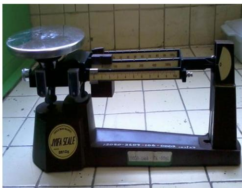
Fig. 6. Balanza para la medición de masa necesaria en la mezcla de sales para fluxado
