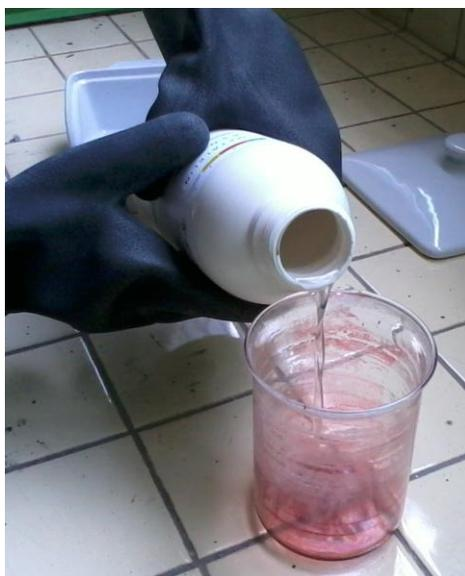
Fig. 2. Medición de volumen de ácido sulfúrico puro en beaker.
