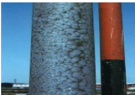
Fig. 1.5. Recubrimiento de aspecto gris mate no uniforme (reticular).
