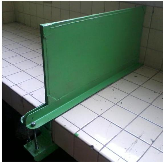
Fig. 3.1. Pantallas separadoras construidas para aislar entre si las diferentes etapas del proceso de galvanizado.
