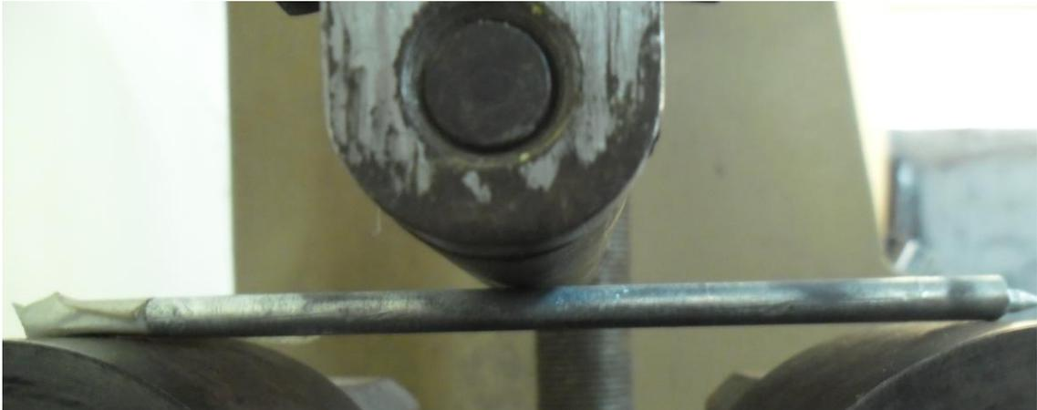
Fig. 3.11. Pieza galvanizada en proceso de ensayo de flexión, dobles hasta  $135^\circ$
