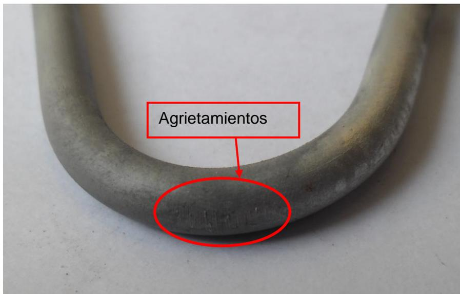
Fig. 3.15. La probeta con 6 min de decapado y 10 s de inmersión en el baño de zinc, presenta agrietamientos del recubrimiento de zinc en zona donde se produjo el dobléz.
