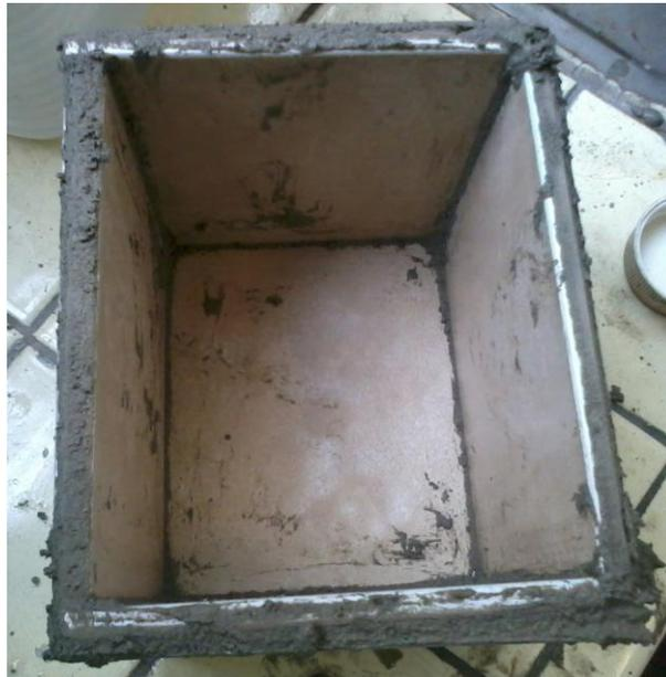
Fig. 3.4. Construcción del crisol finalizada a la espera a que seque el cemento para la realización de pruebas y realizar el proceso de galvanizado
