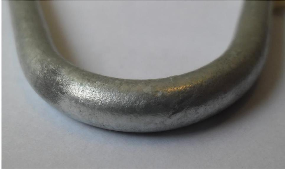
Fig. 3.13. Probeta representativa de todas las probetas que no presentaron fallos.
