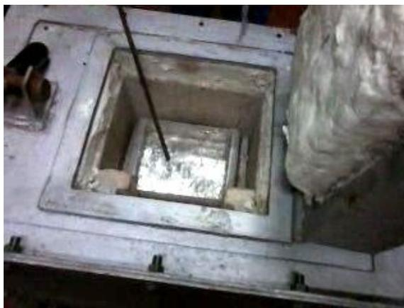
Fig. 3.9. Piezas en proceso de inmersión en caliente, la pieza está dentro de la fundición de zinc, una limpieza al zinc fundido antes y después de la extracción del material es necesaria para que las impurezas de la reacción del material con el zinc fundido no queden en el recubrimiento mismo.
