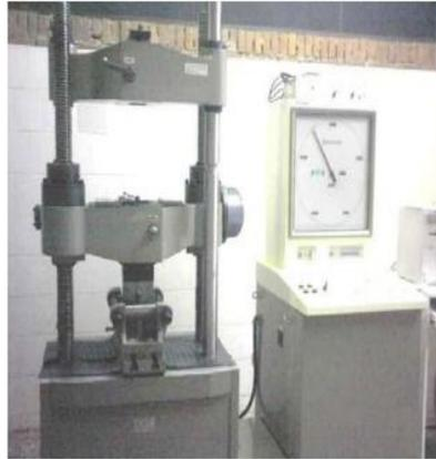
Fig. 1. Máquina para ensayo a flexión.
