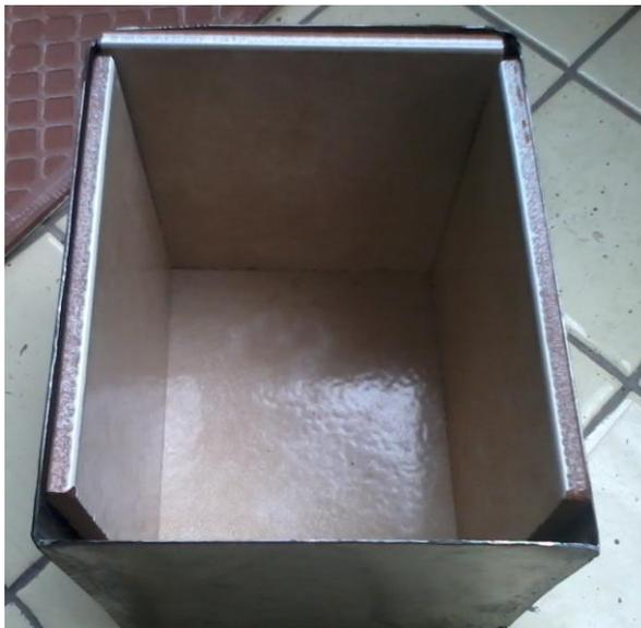
Fig. 3.3. Colocación de la cerámica interna al crisol para galvanizado en la lámina de acero que ya se encuentra soldada en los extremos, según el criterio de diseño que se especificó anteriormente.
