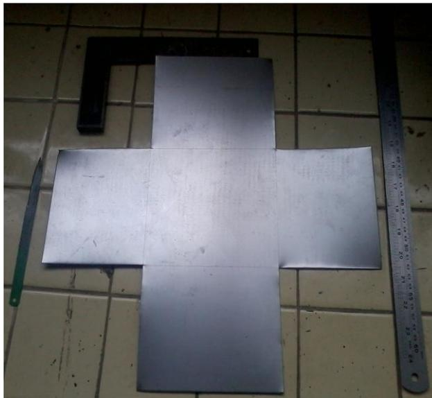
Fig. 3.2. En proceso de corte de la lámina metálica que se utilizará para la construcción del crisol de fundición para el zinc en el proceso de galvanizado.
