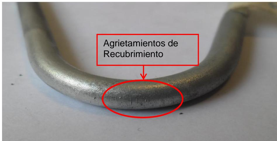
Fig. 3.14. La probeta con 6 min de decapado y 5 s de inmersión en el baño de zinc, presenta pequeñas grietas o desprendimientos producto del doblado.
