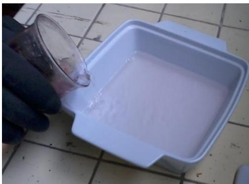
Fig. 3. Vertiendo el ácido sulfúrico puro en un contenedor limpio para su posterior mezclado.
