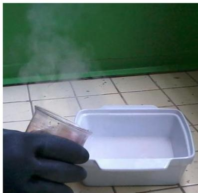
Fig. 5. Mezcla de agua en el ácido sulfúrico puro se aprecia la emanación de vapores producto de la reacción exotérmica que ocurre.
