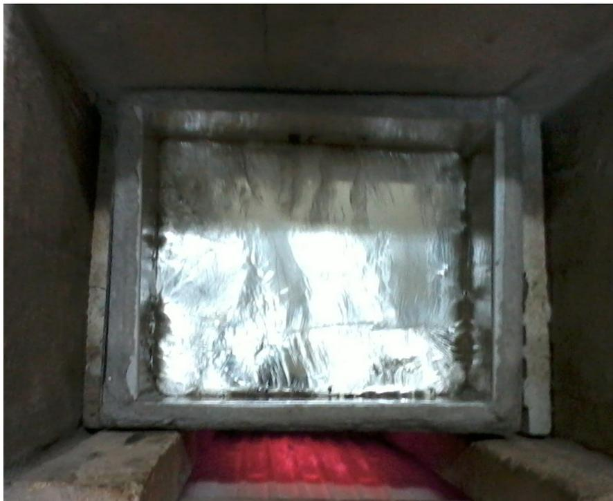
Fig. 3.5. Crisol construido en diferentes pruebas, ha cumplido satisfactoriamente las pruebas de forma (encaja correctamente en el horno) pruebas de temperatura y pasividad con el zinc (no hay contaminación) está listo para galvanizar.
