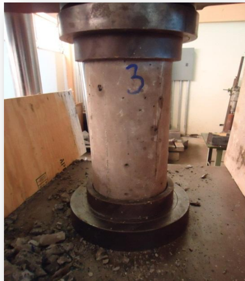
Figura 6.6: Ensayo de Resistencia a Compresión, laboratorio de Suelos y materiales FIA UES, Fuente: Propia
