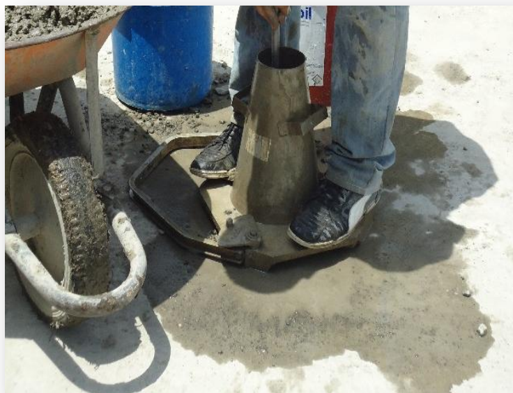
Figura 4.8: Varillado de la primera capa para revenimiento Fuente: Propia
