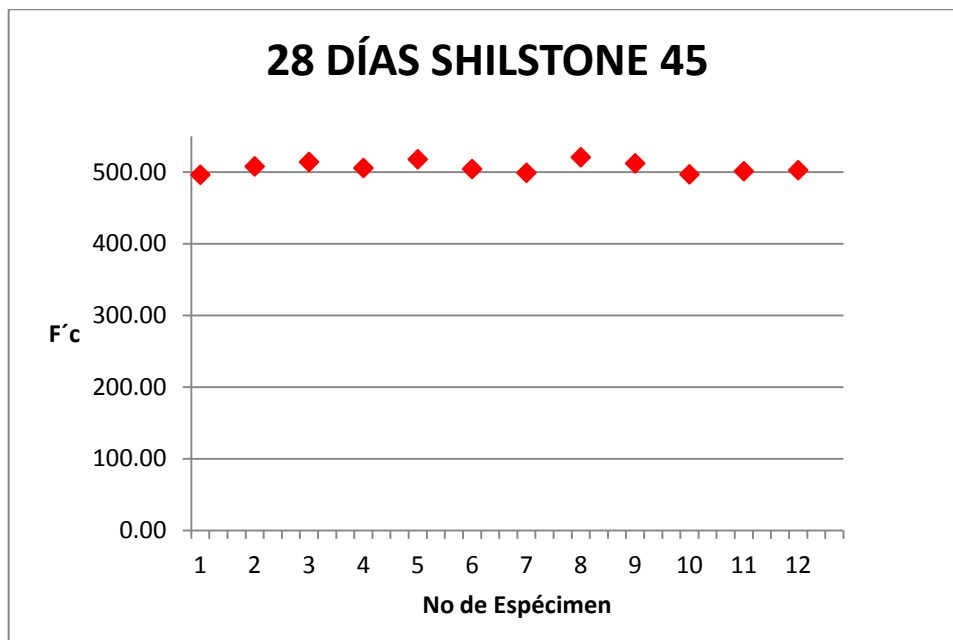
Gráfico 6.19: f'_c Vrs No de Espécimen para Shilstone M_R = 45 \text{ kg/cm}^2 , edad 28 días. Fuente: Propia
